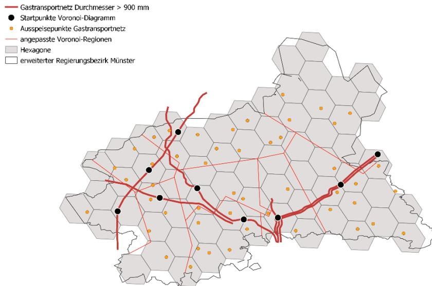
Abbildung 8-3: Verwendete Versorgungsgebiete der Ausspeisepunkte aus dem Gastransportnetz und Verlauf der Leitungen mit einem Durchmesser größer 900 mm des Gastransportnetzes in der betrachteten Region.
