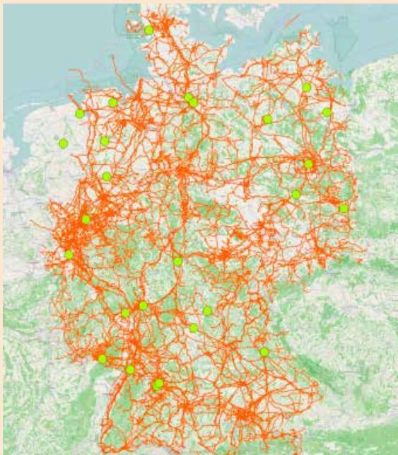
Darstellung des Stromnetzes und der aktuell installierten Power to Gas Anlagen in Deutschland // GWI 2015
