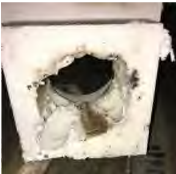
Abbildung 3.37: Brennerstein mit Abschmelzungen (linkes Bild) und überhitzte (verkohlte) Brennerdüse (rechtes Bild), (Quelle: UAS)
