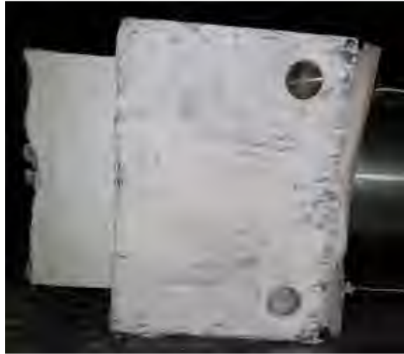
Abbildung 3.35: Ausgebauter Preheating-Brennerstein nach ca. 4 Monaten in Betrieb; Verschleiß auf Düsen-seite (links im Bild) ist deutlich zu erkennen (Quelle: ZK)
