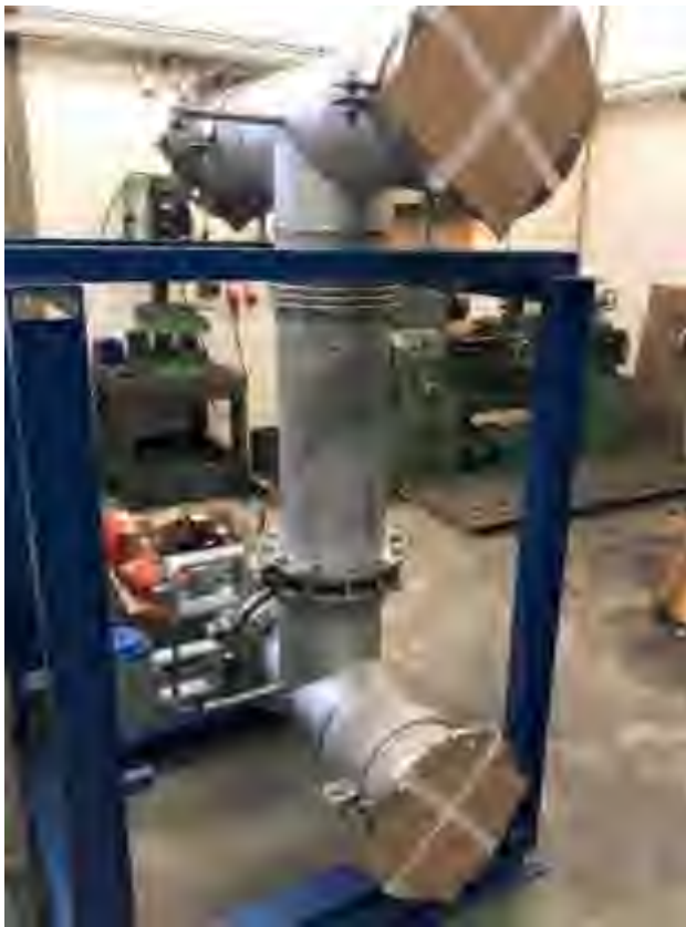
Abbildung 3.18: Heißluftversorgung mit Bypass (Quelle: UAS)
