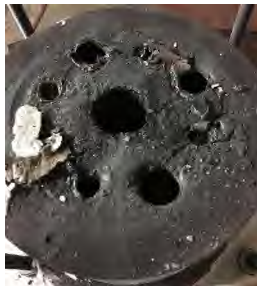
Abbildung 3.37: Brennerstein mit Abschmelzungen (linkes Bild) und überhitzte (verkohlte) Brennerdüse (rechtes Bild), (Quelle: UAS)
