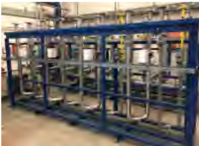
Abbildung 3.16: 4er-Skid, Bypass- und Regelstrecken (Quelle: UAS)
