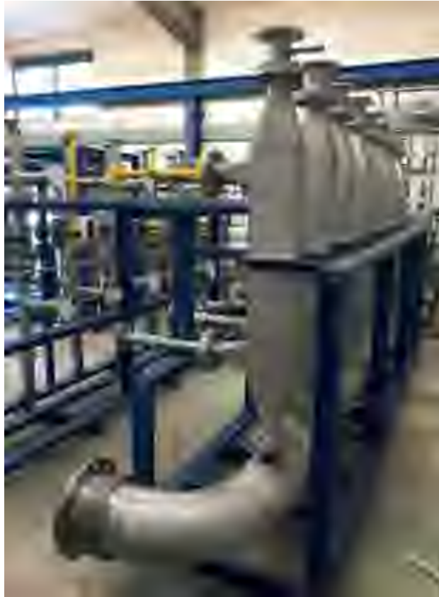
Abbildung 3.17: 4er-Skid, Wärmetauschereinheit (Quelle: UAS)
