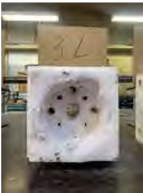
Abbildung 3.39: Brennersteine nach dem Ausbau (Quelle: Zwiesel Kristallglas)
