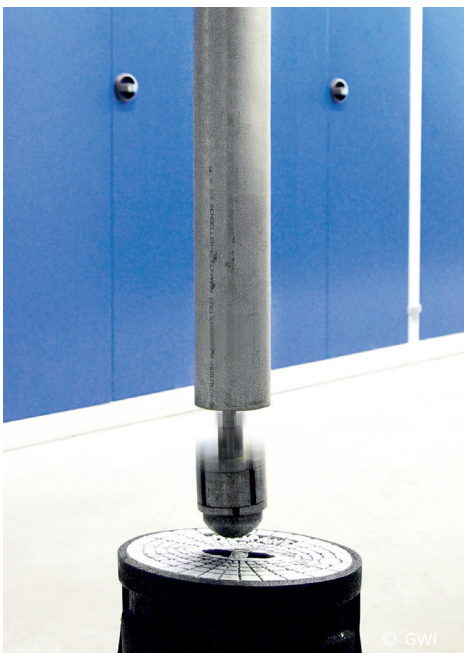
TEST VON STRASSENKAPPEN AUS PE, PA UND GUSSMATERIAL
