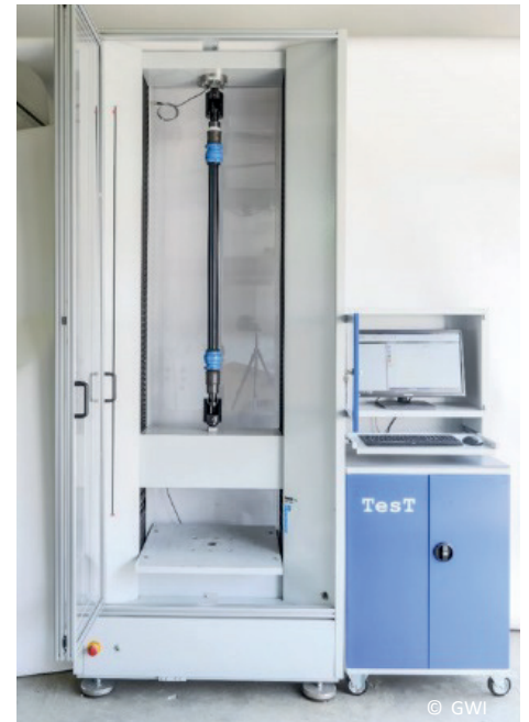
COMPUTERGESTEUERTE ZUG- UND DRUCKKRAFT-PRÜFMASCHINEN MIT BIS ZU 2/50/250 kN UND TEILAUTOMATISIERTE DURCKKRAFTPRÜFUNGEN BIS ZU 500 kN
