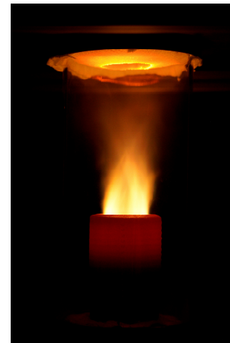
Abb. 3: Labordemonstrator mit Vorwärmzone im Betrieb mit 100\% NH_3 ( P_{\text{Brenner}} = 8\text{ kW} , \lambda = 1,1 , S = 1,1 )
