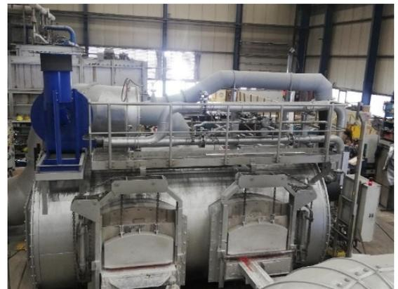
Gießofen zur Sekundär-Aluminiumherstellung © HMT Höfer Metall Technik GmbH & Co KG
