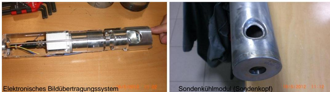
**Abbildung 75: Bewertung von Sondenkühlmodul und elektronischem Bildübertragungssystem nach Industrieinsatz an der Glasschmelzwanne**
