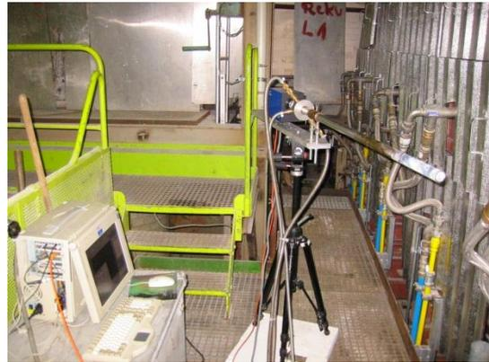
**Abbildung 4: FLORIAN-UV-System im Industrieinsatz an einer Glasschmelzwanne, FSt. DBI, GWI**
