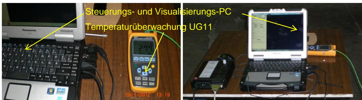
**Abbildung 77:** Industrieerprobung bei der Fa. Telux-Spezialglas GmbH, Steuerungs- und Visualisierungs-PC sowie T-Überwachung im Sondeninneren, Bereich UG11-Wärmeschutz
