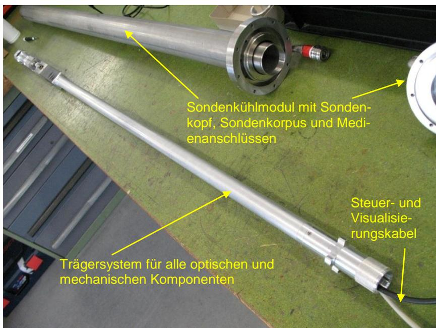
**Abbildung 46:** Gefertigtes Sondenkühlmodul und entwickeltes Trägersystem für alle optischen und mechanischen Bauteile des Lichteintrittssystem (AS 2.2) und des Detektorsystems (AS 2.3)
