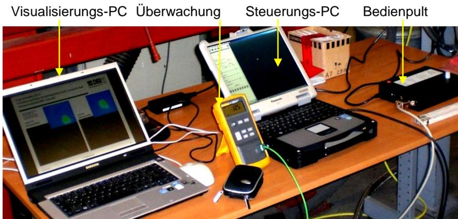
**Abbildung 53:** Visualisierungs-PC, Steuerungs-PC, Überwachung und Bedienpult für die Fernsteuerung der beweglichen optischen Komponenten, des Restlichtverstärkers sowie der Spezialkamera
