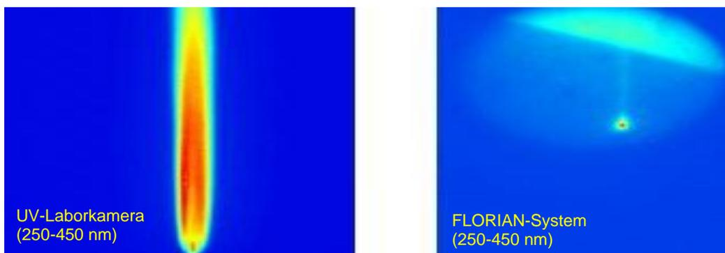
**Abbildung 13:** Flammen eines Schweißbrenners, aufgenommen mit verschiedenen Detektionssystemen, FSt. DBI
