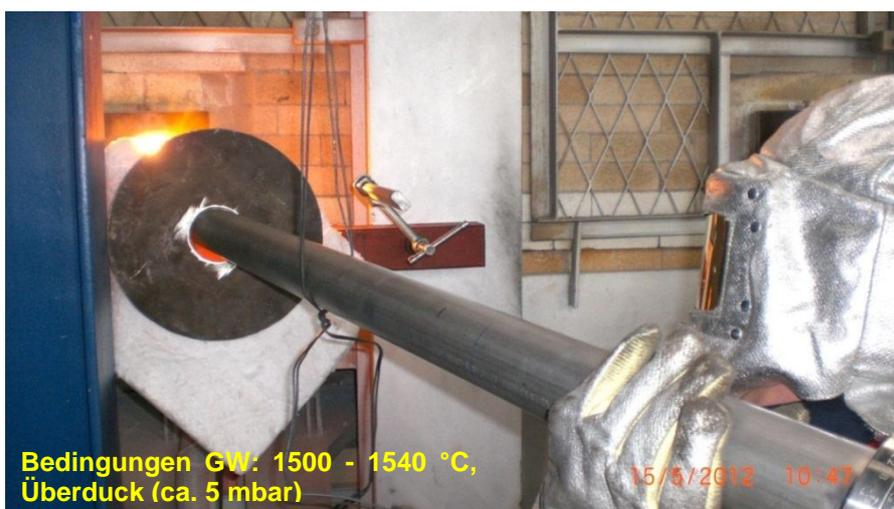
Abbildung 72: Industrieerprobung des UV-Analysesystems bei der Ritzenhoff AG; Einbau des Sondenkuhlmoduls mit voll-elektronischem Bildubertragungs- und Detektorsystem in die Glasschmelzwanne
