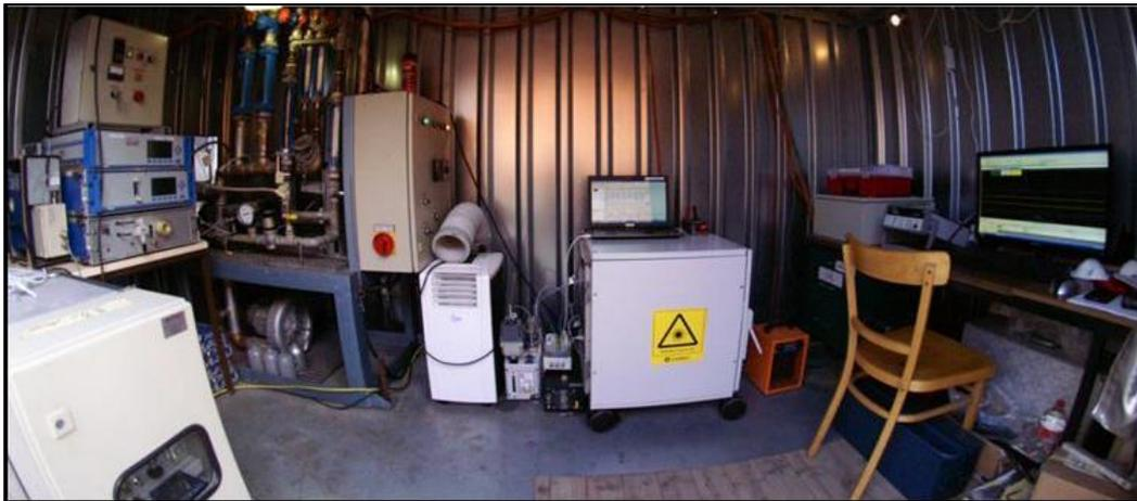
**Abbildung 6-27:** Die für die Messung in der Resteverwertung optimierte Raman-Sonde (mit gelben Laser-Aufkleber) im Messcontainer (Quelle: Esytec)
