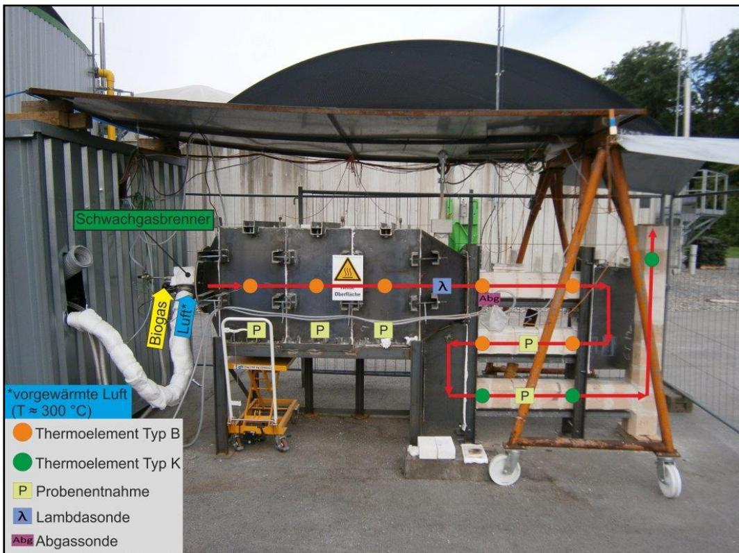
Abbildung 5-15: Verteilung der Messstellen in der mobilen Versuchsanlage und Entnahmestellen für Abgas (Quelle: GWI)
