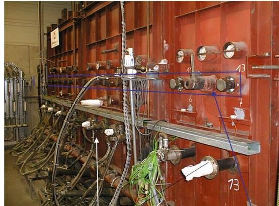
**Abbildung 5-4** ist der GWI-Versuchsofen dargestellt. An dieser Anlage können die Bedingungen des Verbrennungsvorgangs in Glasschmelzwannen nachgestellt werden. Gleichzeitig ist der Ofen, im Gegensatz zu industriell genutzten Glasschmelzwannen, speziell auf eine gute messtechnische Zugänglichkeit hin ausgelegt worden.
