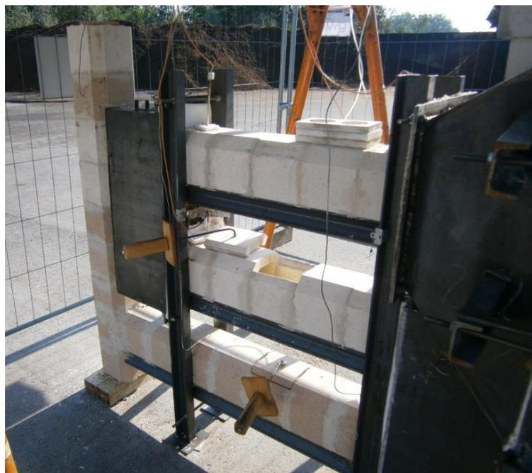
Abbildung 5-3: Abgaskanal mit Probenöffnungen (Quelle: GWI)
