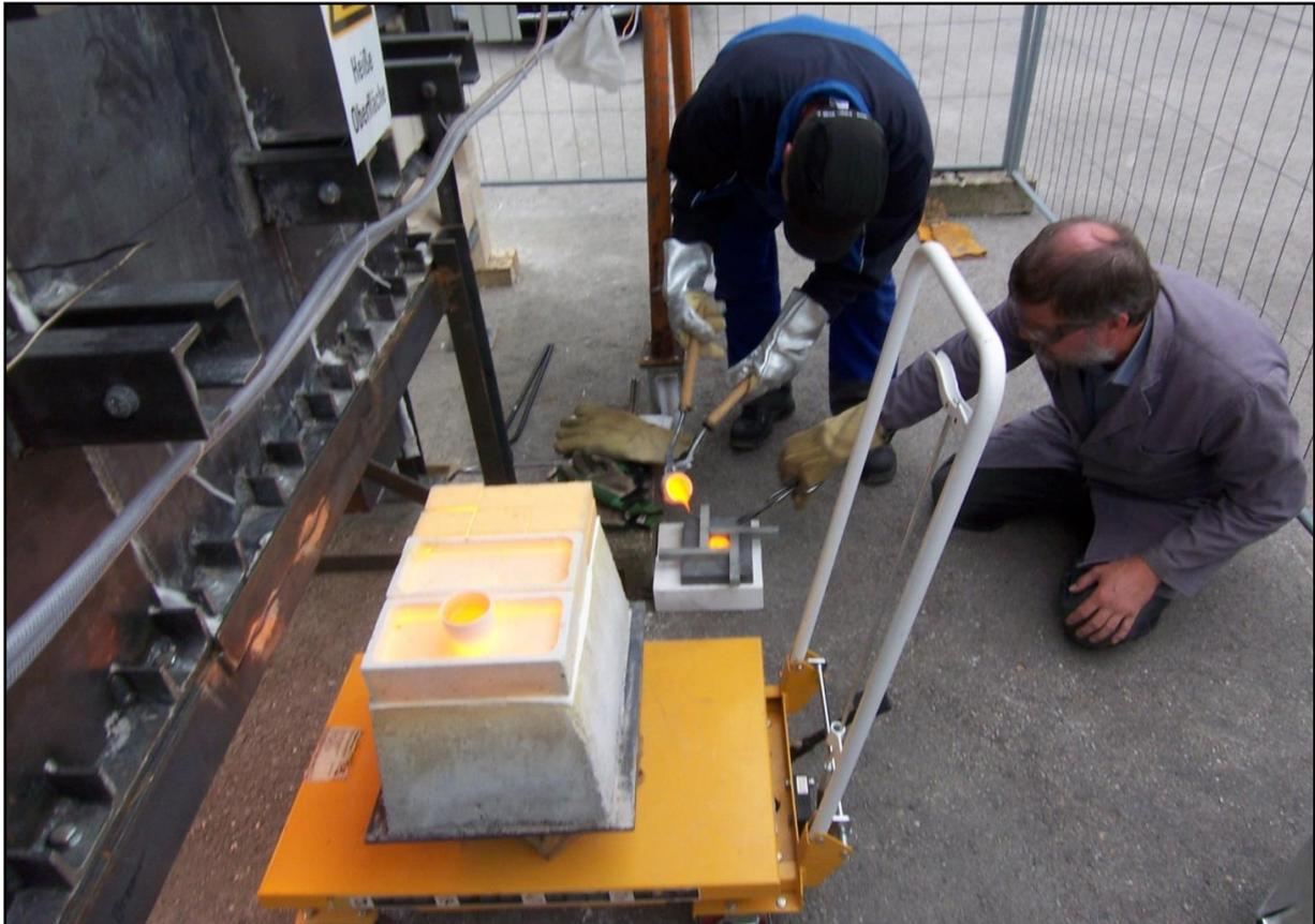
**Abbildung 5-12:** Glasguss vor Ort an der mobilen Versuchsanlage (Quelle: GWI)
