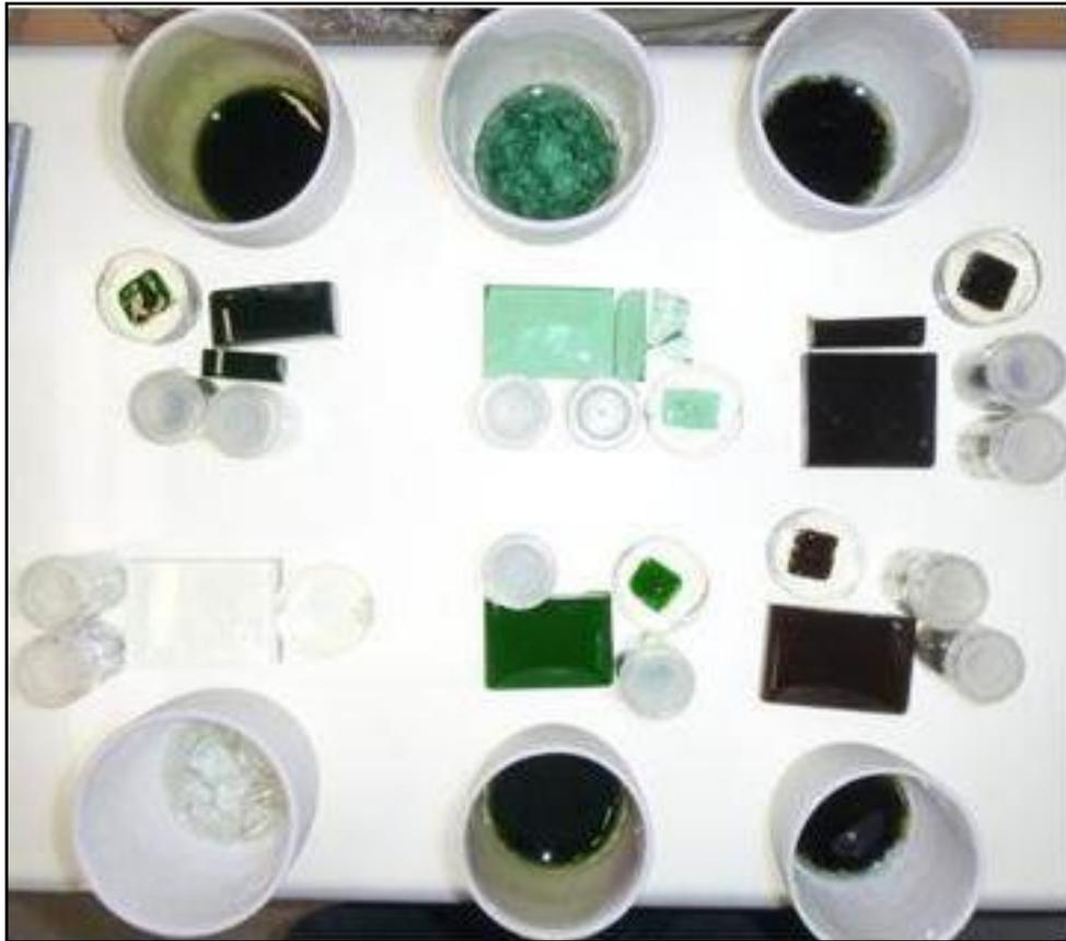
Abbildung 6-36: Glasproben, im Elektroofen der HVG erschmolzen (Quelle: HVG)
