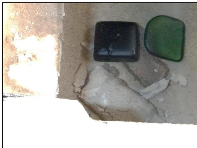
**Abbildung 5-13:** Tempern einer Grün-, Braun und Floatglasprobe im Abgaskanal der mobilen Brennkammer (Quelle: HVG)
