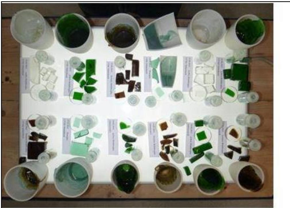
**Abbildung 6-23:** Glasproben, mit Erdgas als Referenz für die Biogasbefuerung erschmolzen (Quelle: HVG)
