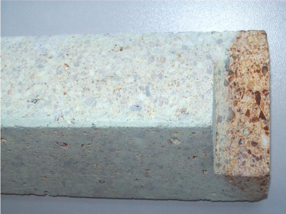
**Abbildung 6-35:** Besonders starke Kondensation und Ablagerung von hellen Sulfatsalzen auf dem Topfstein
