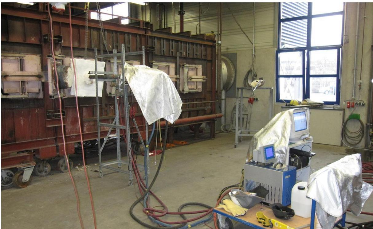
Abbildung 5-17: Spektralradiometer der HVG im Einsatz am Hochtemperaturofen des GWI (Quelle: GWI)
