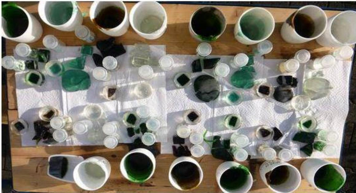
**Abbildung 6-26:** Glasproben, mit dem Biogas der Resteverwertung erschmolzen (Quelle: HVG)
