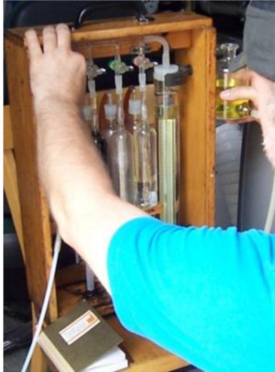
Abbildung 5-14: Messung der Hauptinhaltsstoffe der Biogase mit dem ORSAT-Apparat (Quelle: HVG)
