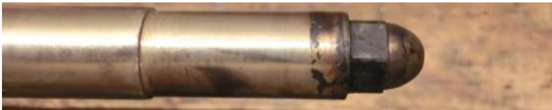
Bild 26: Überschallsauerstoffbrenner für den Betrieb mit leichtem Heizöl
