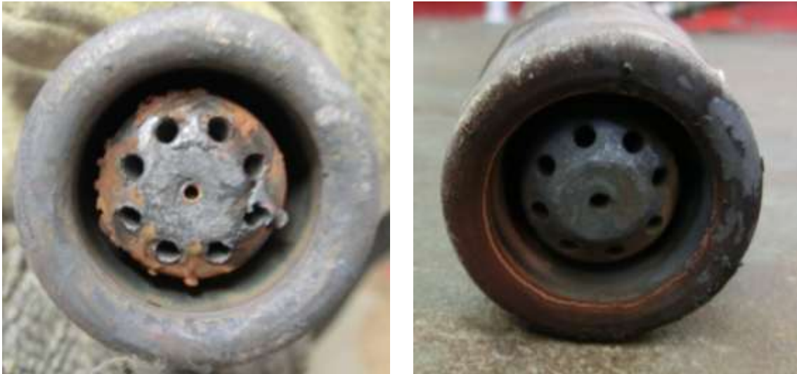
Bild 35: Aufnahmen der Gaslanzenvariante mit einer zusätzlichen zentralen Gasdüse nach Einsatz im Versuchsofen
