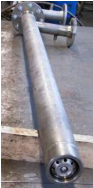
Bild 92: fertiggestellter Überschall-Kombibrenner für den Erdgas-Sauerstoff- und Öl-Sauerstoff-Betrieb
