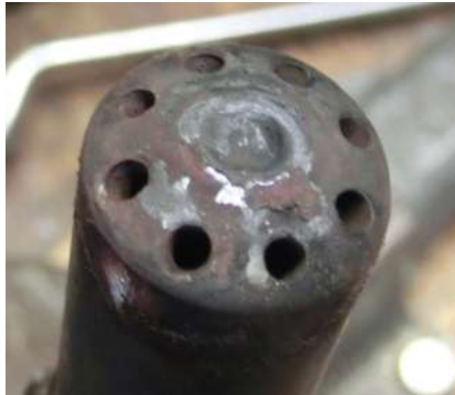
Bild 39: Verzunderte Brennerlanze nach Untersuchungen mit Erdgas an der Lanzenposition E+2
