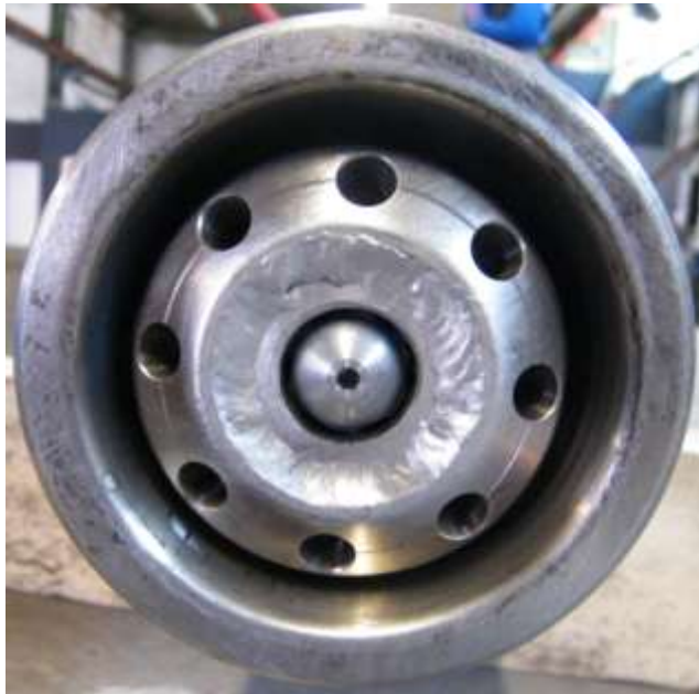
Bild 92: fertiggestellter Überschall-Kombibrenner für den Erdgas-Sauerstoff- und Öl-Sauerstoff-Betrieb
