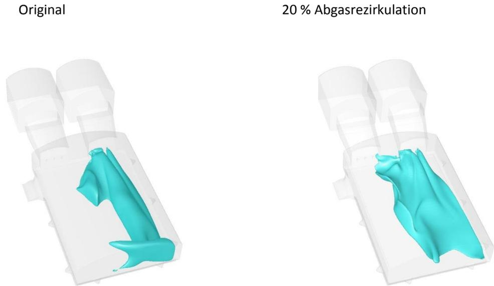
Abbildung 6-34: CO-Isosfläche (6000 ppm trocken) im Originalzustand ohne Abgasrezirkulation
