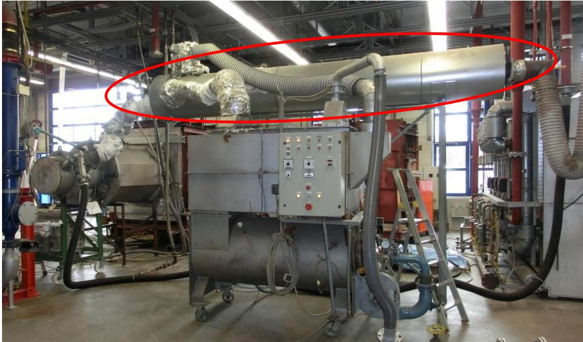
Abbildung 3-41: Versuchsstand, Gasvorwärmer und Luftvorwärmer
