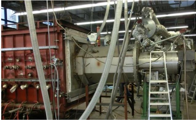
Abbildung 3-39: Aufnahme des Versuchsstandes mit Brenner und Brennkammer
