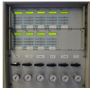
Abbildung 3-40: Bedienoberfläche Gasmischanlage im GWI
