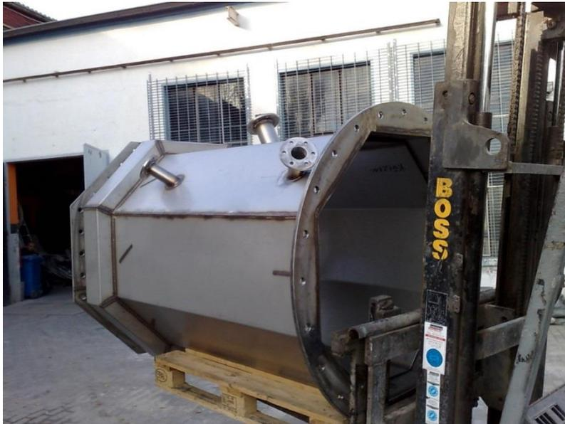
Abbildung 3-323: Bau des ersten Prototypen mit Stützen
