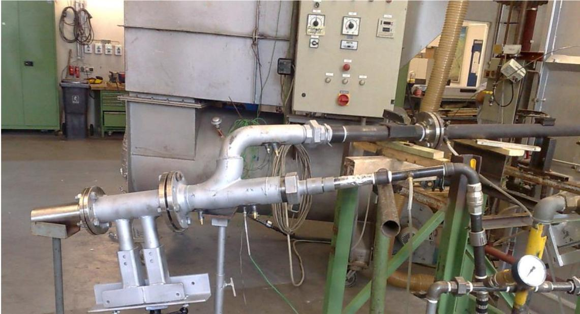
**Abbildung 3-36: Versuchsstand mit Metaldüse**
