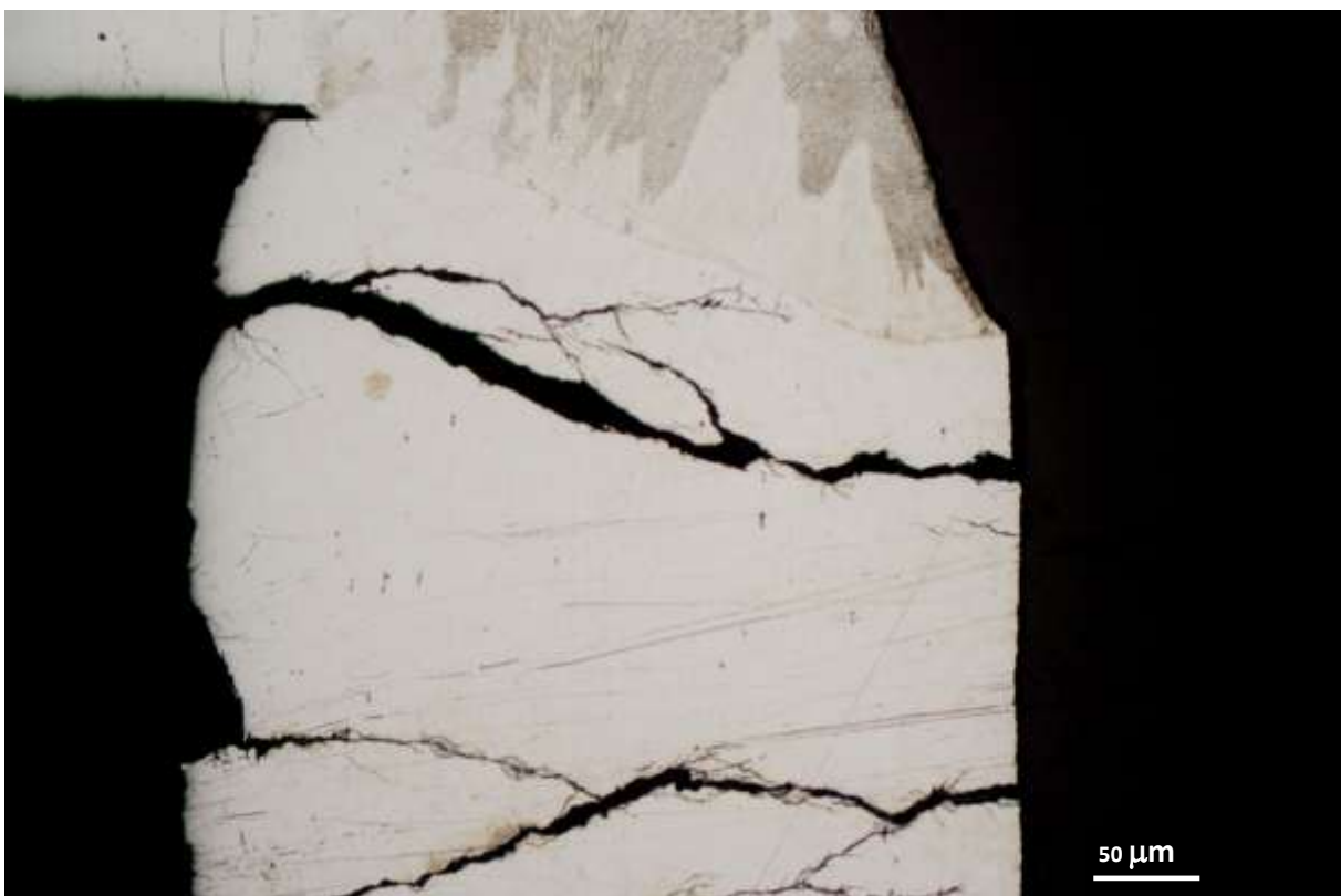
Abbildung 2-25: Ausgeprägte Rissverzweigung und teilweise herausgebrochene Oberflächenbereiche
