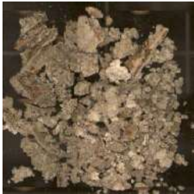
Abbildung 2-14: Analyzierte Ablagerungen Bereich 2 (Innenwand)
