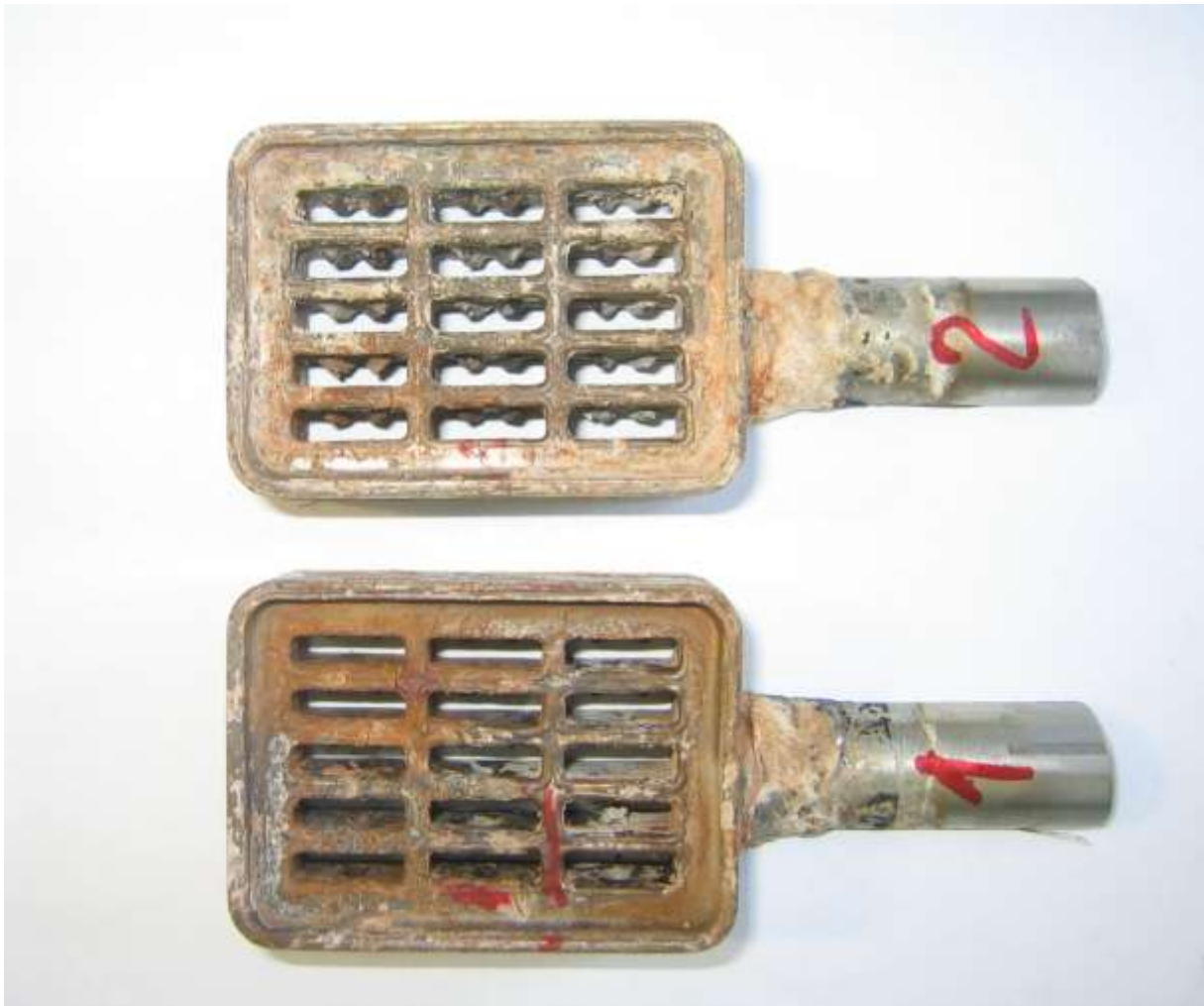
Abbildung 2-22: Abgesägte Wärmetauscher-Böden mit Winglet-Kanälen
