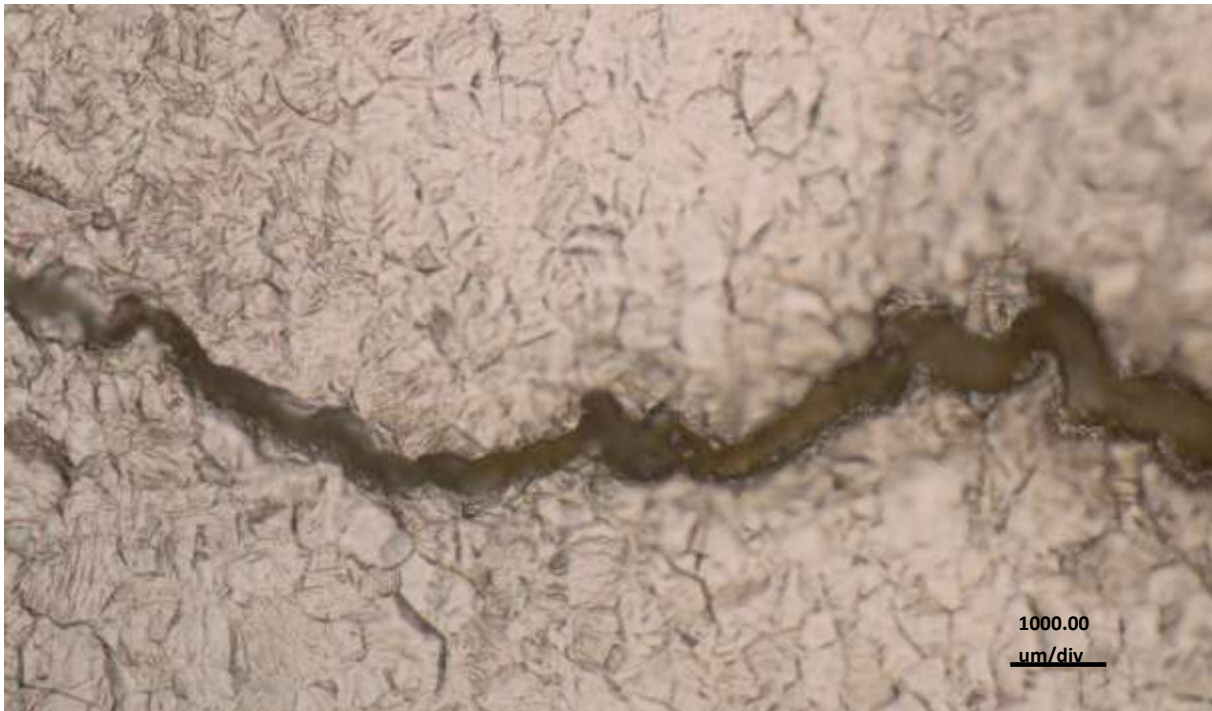
Abbildung 2-24: Vergrößerung der Rissbildung; interkristalline Kriechschädigungen
