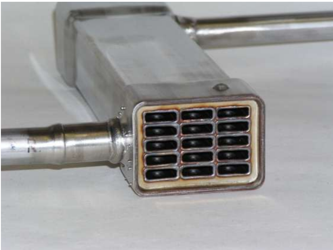
Abbildung 2-36: Wärmetauscher vor der Reinigung
