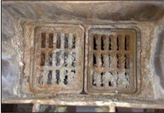
Abbildung 2-11: Sichtbare Ablagerungen an der Halterung (rechts) und den Böden (links) des WTs
