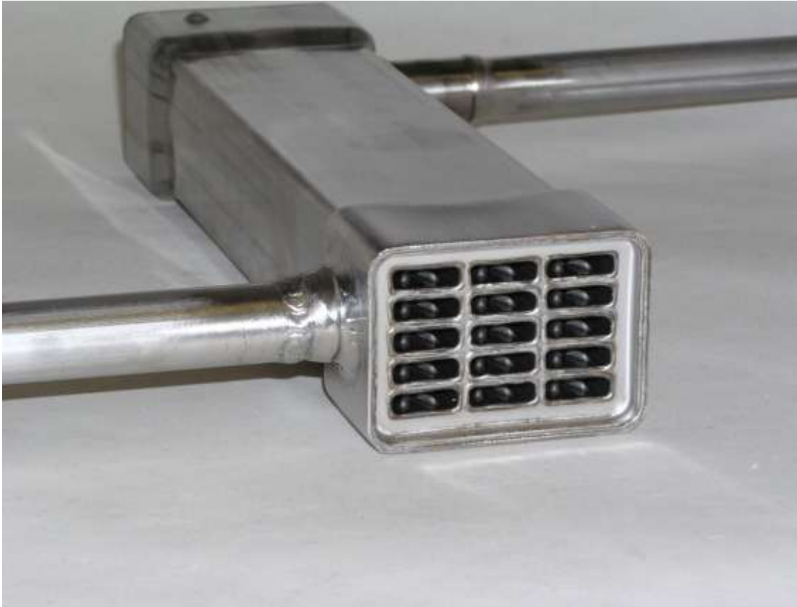
Abbildung 2-37: Wärmetauscher nach der Reinigung
