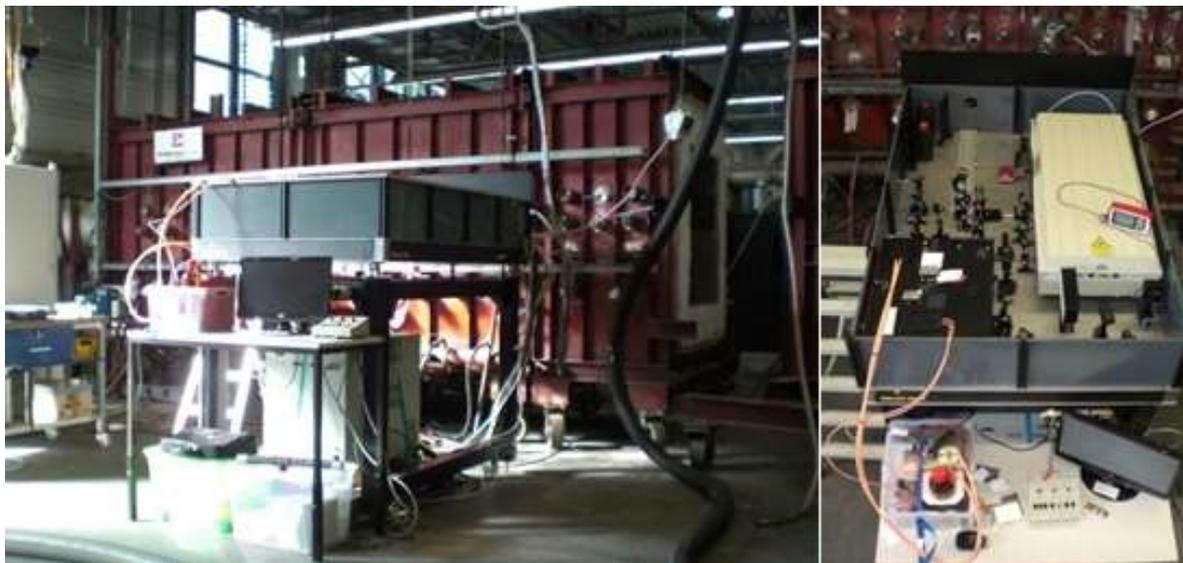
Bild 61: Vibrations-CARS-Messsonde am Oxy-Fuel-Brenner-Prüfstand am Gas- und Wärme-Institut in Essen (Quelle: Universität Siegen)
