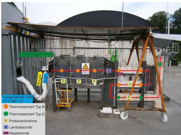
Abbildung 2.3: Mobiler Versuchsstand an einer NaWaRo-Biogasanlage mit verschiedenen Messstellen zur Charakterisierung der Verbrennungstrecke (Quelle: GWI).
