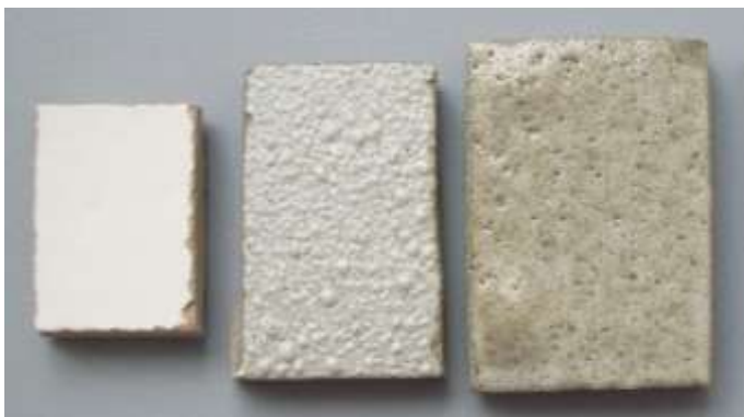
Abbildung 6.22: Geschrübte Fliese mit aufgetragener Glasur (links) und nach 2 und 4 Stunden Überfeuerung.
