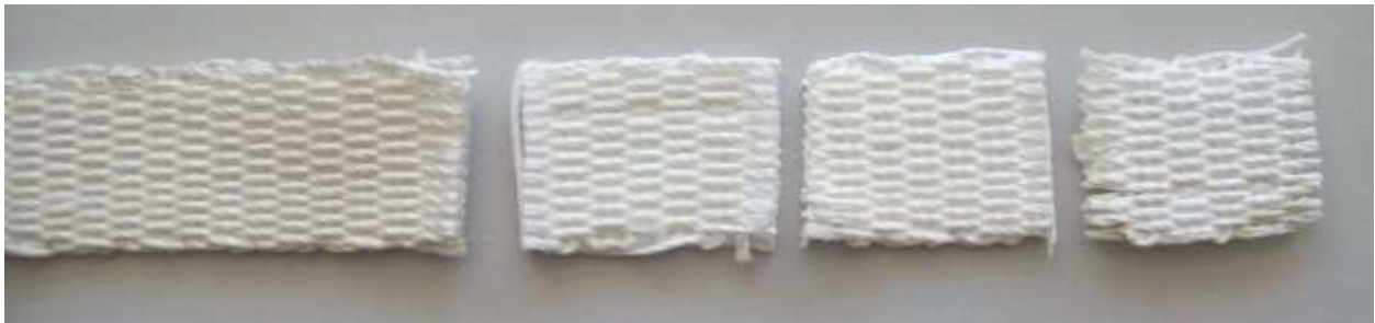
Abbildung 6.36: Keramische Flachdichtung aus der Produktion (links) und nach 8 (2. v. links), 24 (3. v. links) und 48 (rechts) Stunden Befeuerung.
