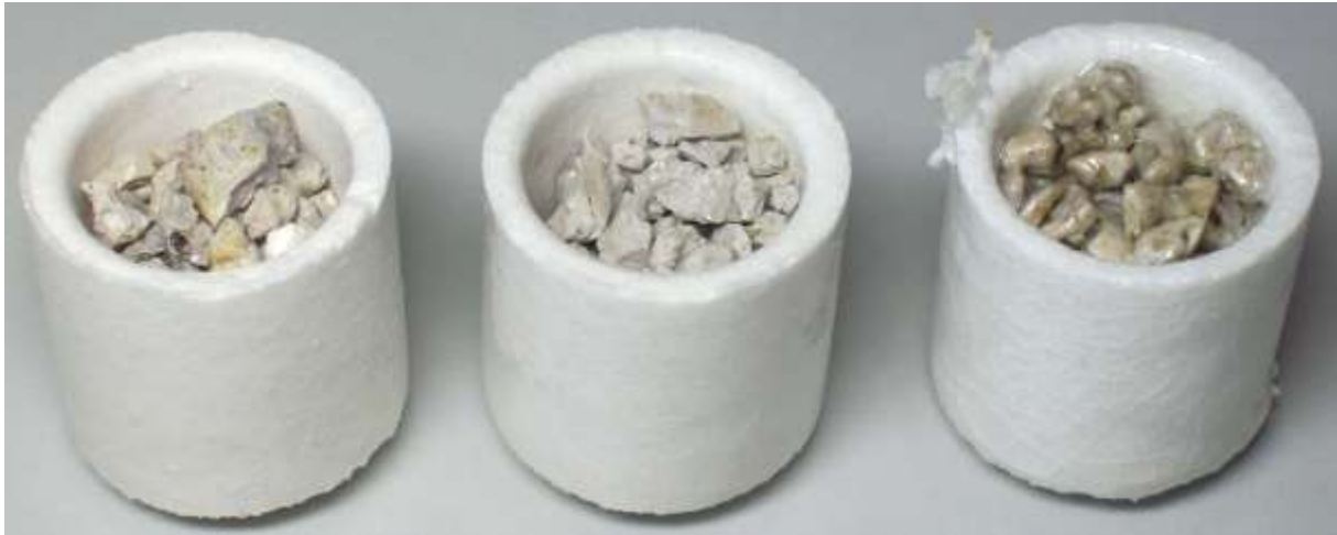
Abbildung 6.37: Mullit-Körnung nach 8 (links), 24 (Mitte) und 48 (rechts) Stunden Befeuerung.
