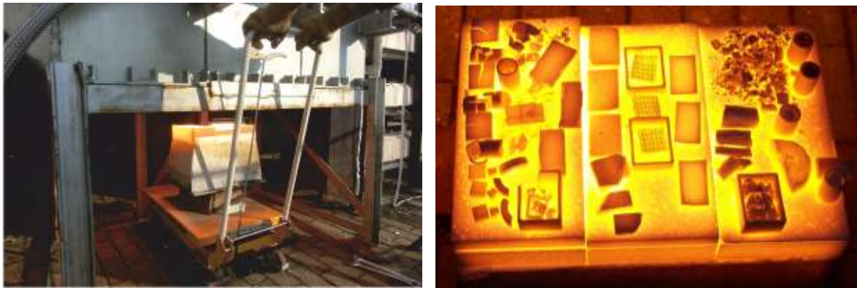
Abbildung 4.14: Probenentnahme am mobilen Versuchsofen (links) und bestückter Probenträger (rechts) nach Befuerung mit Erdgas und Wasserstoff kurz vor der Probenahme.
