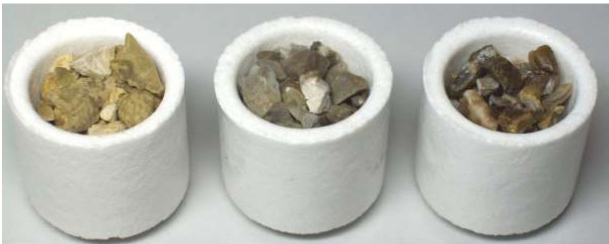
Abbildung 6.38: Bauxit-Körnung nach 8 (links), 24 (Mitte) und 48 (rechts) Stunden Befeuerung.
