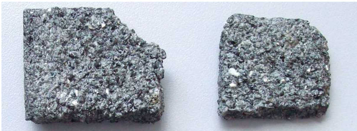
Abbildung 6.39: Siliciumcarbid-Körnung im SiC-Produkt nach 24 (links) und 48 (rechts) Stunden Befeuerung.
