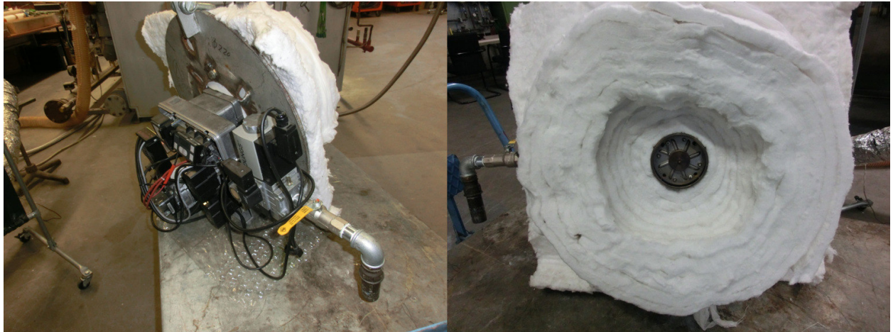
Abbildung 14: Vorder- und Rückansicht des Brennersystems II in einbaufertigem Zustand mit Fasermantel
