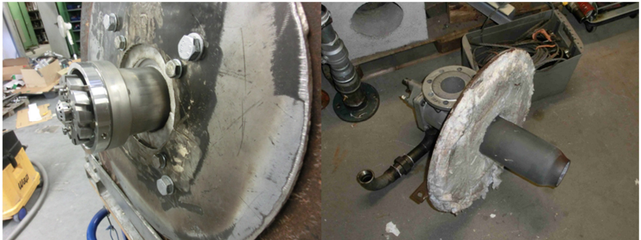
Abbildung 13: Brennersystem I mit und ohne Flammrohr in einbaufertigem Zustand mit Montageplatte
