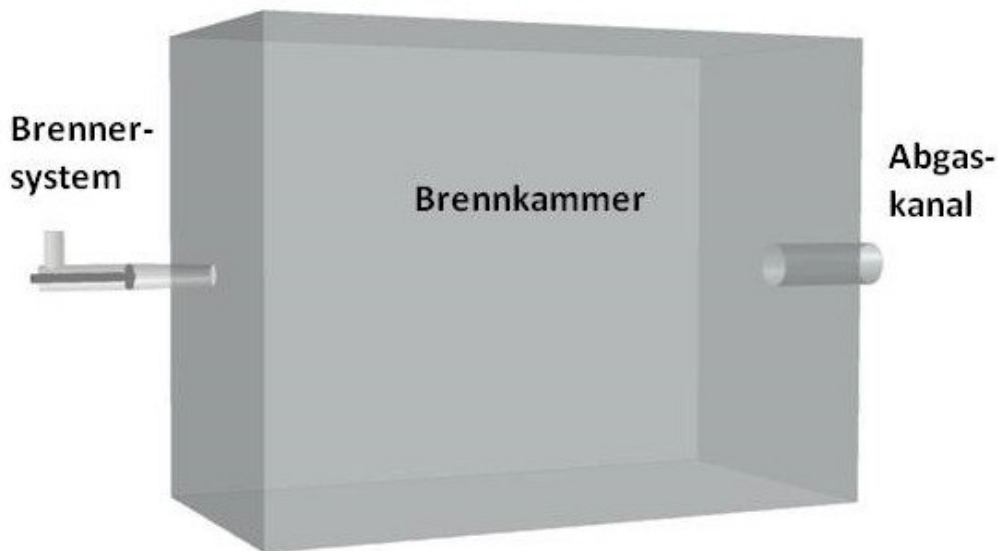
Abbildung 62: Geometrie des Versuchsofens mit Brennersystem I
