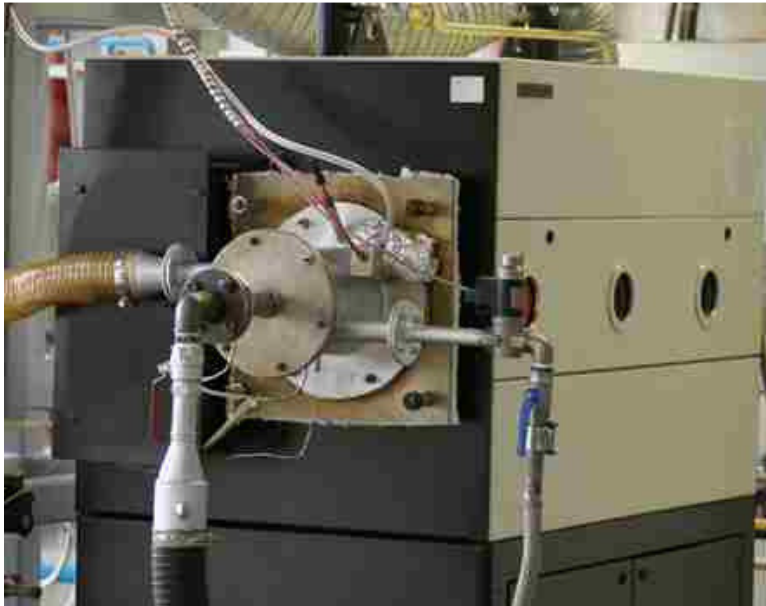
Abbildung 51: Prüfflammrohr mit installiertem Versuchs Brenner
