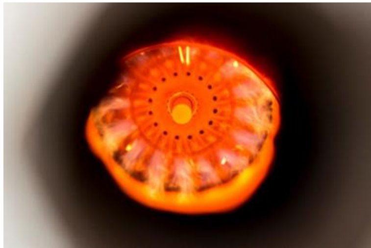
Abbildung 6.7: Flammenbild im 100 kW-Kombibetrieb mit HEL und Biogas.
