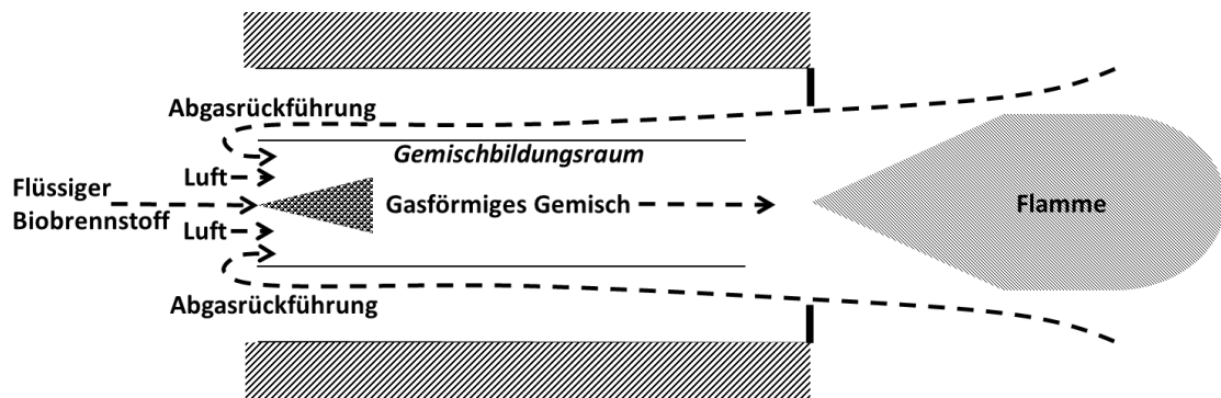
Abbildung 3.2: Interne Abgasrezirkulation zur Vorverdunstung des flüssigen Brennstoffs.
