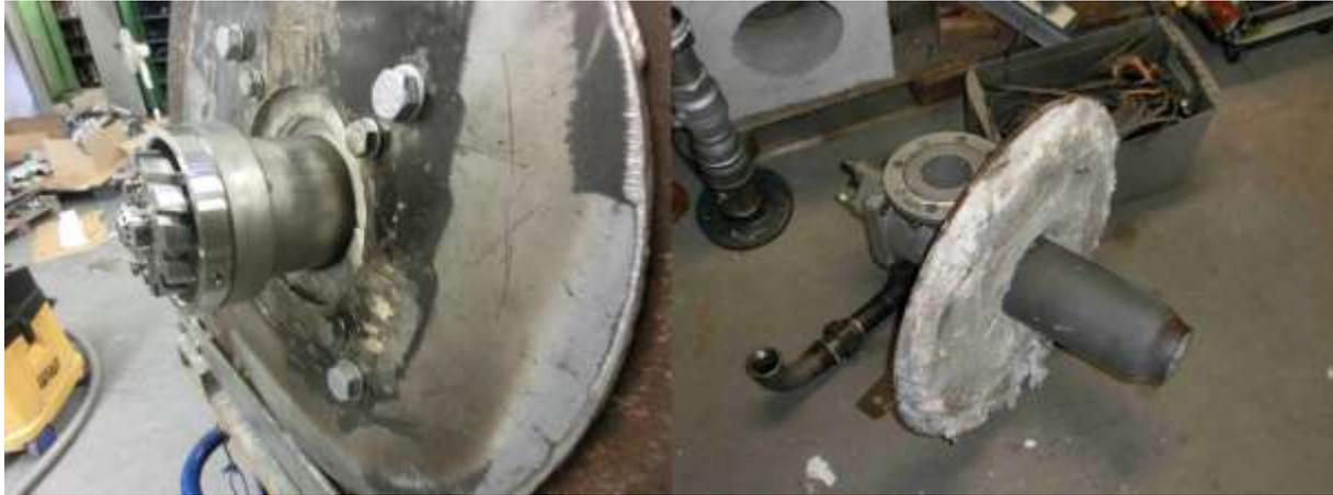
Abbildung 3.20: Brennersystem mit und ohne Flammrohr in einbaufertigem Zustand (Quelle: GWI)
