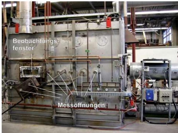
Abbildung 3.18: Seitenansicht des GWI Versuchsofens (Quelle: GWI)
