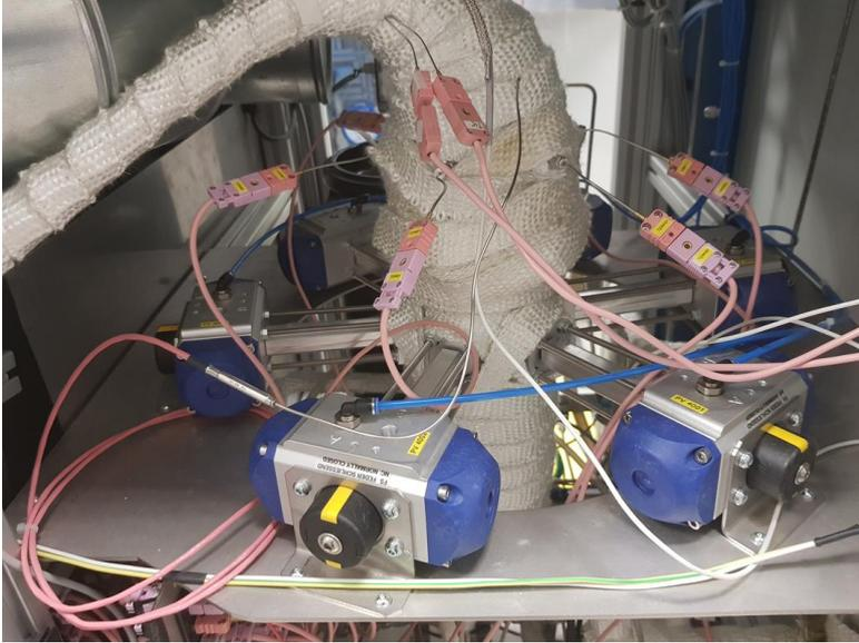
Abbildung 13: Beheizte Analysestrecke mit Umschaltventilen des OCM-Demonstrators
