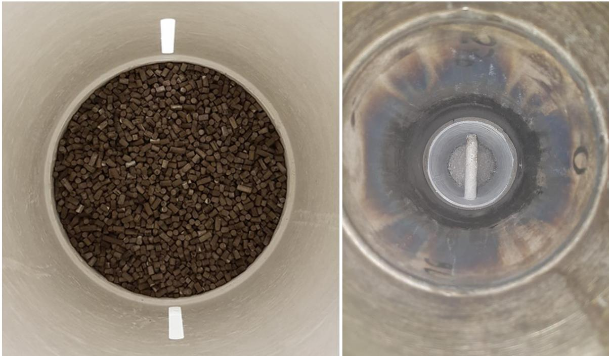
*Abbildung 17: Mit Katalysator befüllter Keramikkorb (l.) und in den Reaktor eingebauter Katalysator mit Raschig Ringen (r.)*
