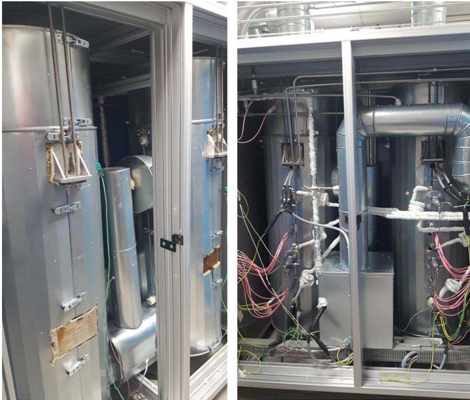
Abbildung 9: Installierte OCM- Reaktoren Vorderansicht (l.) und Rückansicht (r.)
