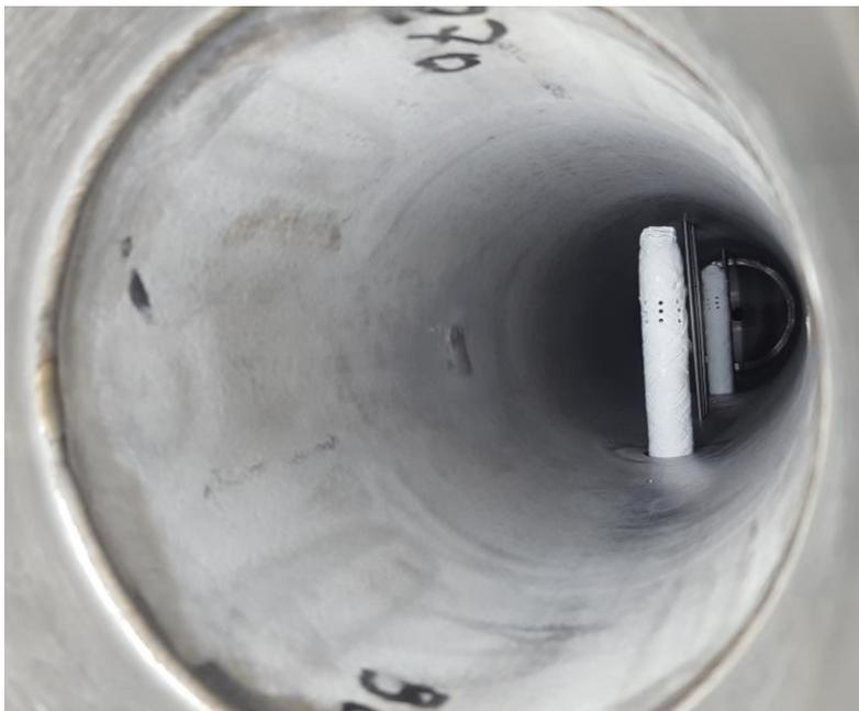
Abbildung 10: Reaktor mit Einbauten (ohne Katalysator und keramischer Auskleidung)
