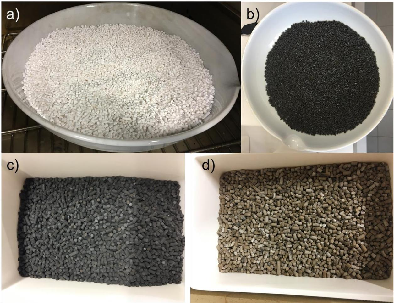
Abbildung 3: Fotografische Aufnahmen von a) getrocknetem  $\text{SiO}_2$ -Trägermaterial, b)  $\text{Mn/SiO}_2$  nach der Nitratzersetzung, c) dem getrockneten ( $T = 99 \text{ }^\circ\text{C}$ )  $\text{Na}_2\text{WO}_4/\text{Mn/SiO}_2$  und d) dem kalzinierten  $\text{Na}_2\text{WO}_4/\text{Mn/SiO}_2$ .
