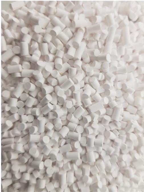
*Abbildung 24: Katalysator nach dem Einsatz im OCM-Demonstrator*
