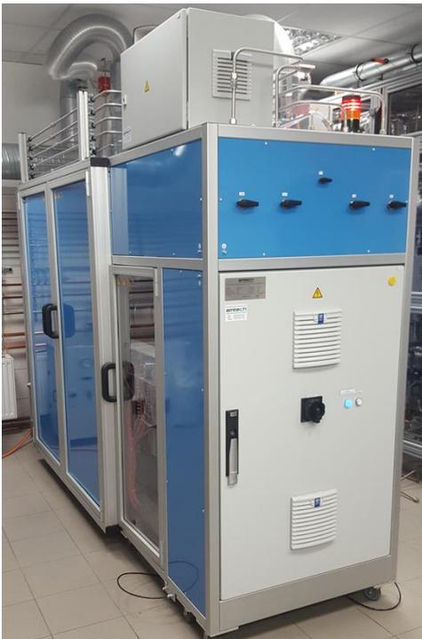
Abbildung 14: OCM-Demonstrator zur Erzeugung höherer Kohlenwasserstoff aus Biomethan
