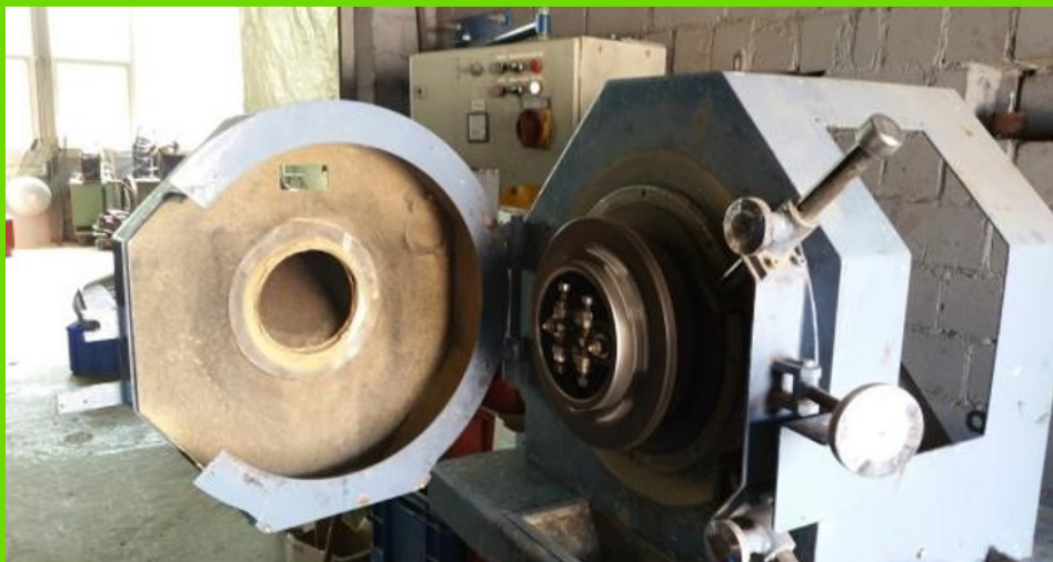
Ringmatrizen-Pelletierer zur Herstellung von Agro-Pellets
