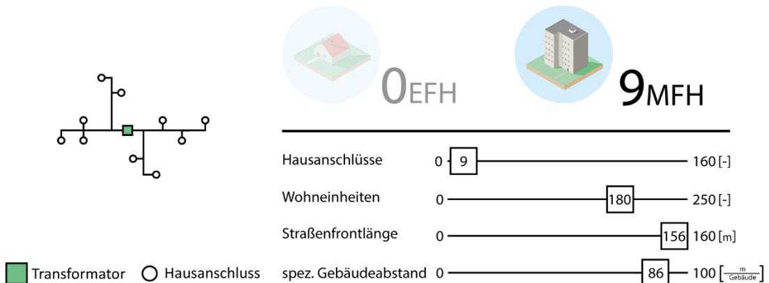
Abbildung 4-8: Struktureller Aufbau und Kennwerte der Typologie 5 – Hochhäuser und große Zeilenbebauung
