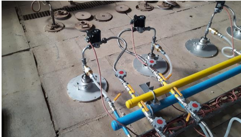
Abbildung 3.32: Detailsansicht aus der neuen Injektorbrennergruppe [LINGL]
