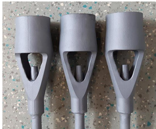
Abbildung 3.58: Brennerdüsenkonstruktion aus SiC-Keramik [LINGL]
