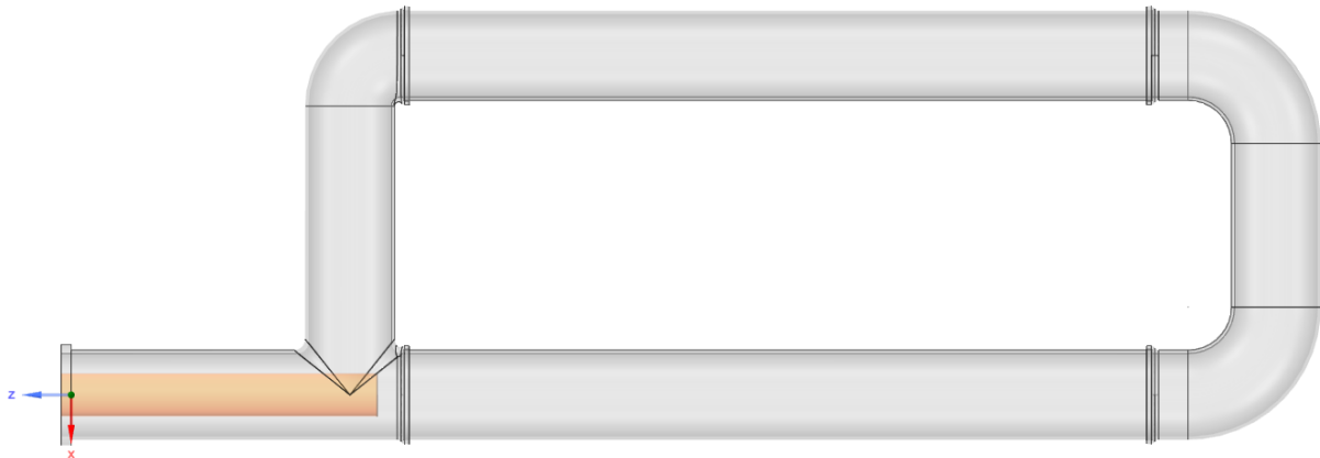
Abbildung 3-28: P-Rohr-Aufbau für das Sim.-Modell; Brenner in orange skizziert (Quelle: GWI)
