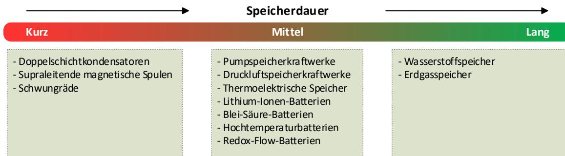
Abbildung 1.5: Speicherdauer der verschiedenen elektrischen Speicher
