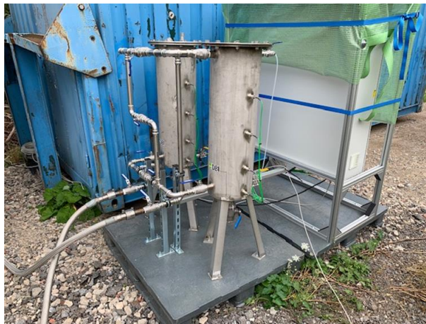
Abbildung 5.3: Gasaufbereitung mit Analytik an Biogasanlage Dornberg. (Quelle: DBI)
