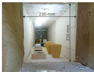
Abbildung 6.2: Mobile Brennkammer - Innenansicht mit Blick auf die Stirnwand und Brennermund, beladener Zustand mit Schmelzprobenbehältern im Vordergrund. (Quelle: GWI)
