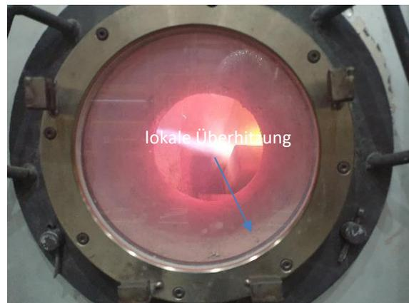
**Abbildung 3.28:** 5 t Ofen mit geöffneter Ofentür und Reinaluminiumblöcken während des Ladevorgangs auf der linken Seite; rechts: Flambild der alten Brenner, die lokale Überhitzung der Schrotte durch die auftreffende „lange“ Brennerflamme ist deutlich sichtbar. (Quelle: Trimet)
