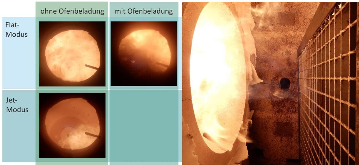
**Abbildung 3.15** :Flammenbilder diverser Betriebszustände mit dem Blick auf den Brennermund (li.); Flat-Modus mit Ofenbeladung seitlich fotografiert (re.) (Quelle: GWI)
