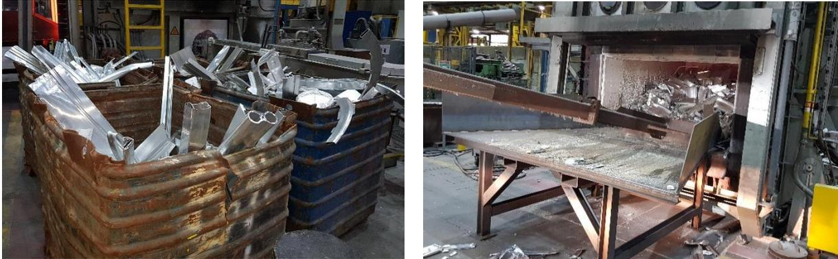
**Abbildung 3.30: Si<sub>0,5</sub> Profilschrotte mit geringem Anteil an Verunreinigungen (Quelle: Trimet)**
