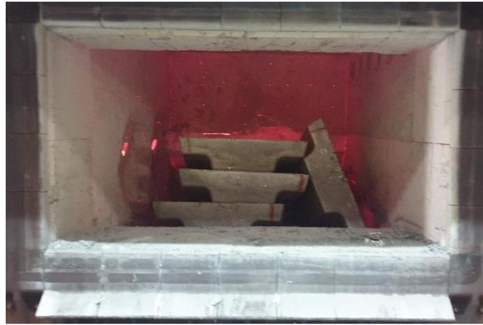
**Abbildung 3.29: Reinaluminiumblöcke gestapelt im 5 t Versuchsofen mit Brennersteinen auf der linken Seite (Quelle: Trimet)**
