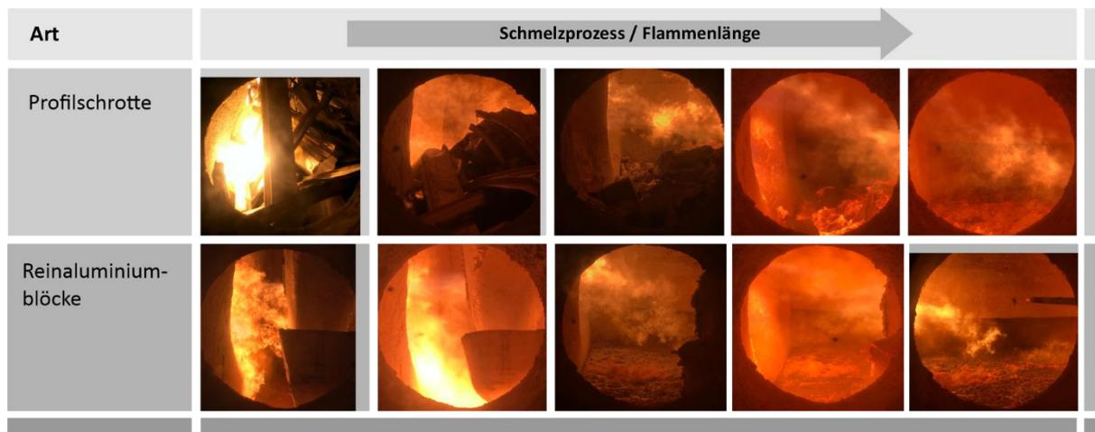
**Abbildung 3.40: Flammenausbildung in Abhängigkeit der Beladung des Ofens (Quelle: GWI)**
