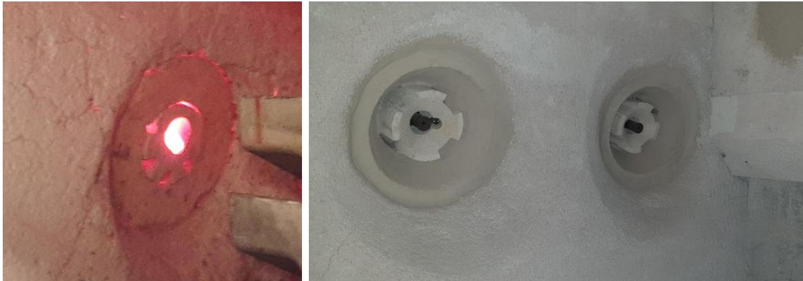
**Abbildung 3.31: links: alter Brennerstein (nur vorderer Brenner) und rechts: neue Brennerstein (vorne und hinten) des regenerativen Systems im 5 t Versuchsofen (Quelle: TRIMET)**
