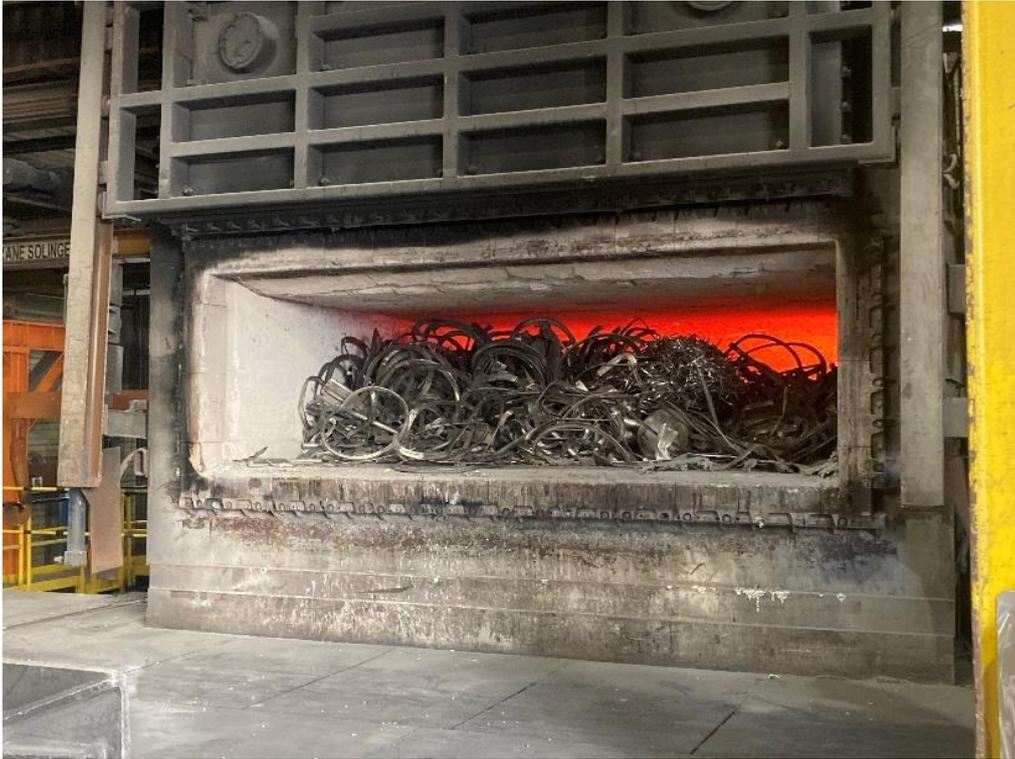
**Abbildung 3.42: Vollständig, mit Schmiederesten aus der Felgenreherstellung, befüllter Ofenraum.
