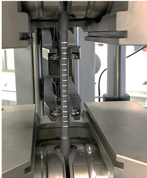
Abbildung 36: Eingespannte Zugprobe mit Markierungen zur Bestimmung der Bruchdehnung (Quelle: TH Köln)
