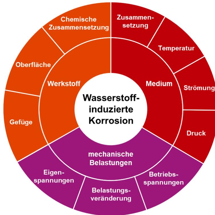
Abbildung 89: Einflussfaktoren der wasserstoffinduzierten Korrosion (Quelle: TH Köln)
