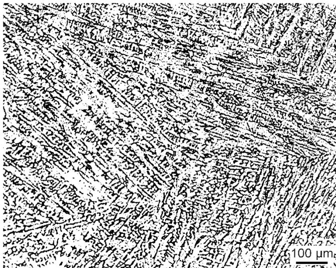
Abbildung 63: Metallographische Gefügaufnahme des AlSi7Cu0,5Mg nach erneutem Aufschmelzen in 100 % H<sub>2</sub> (Quelle: TH Köln)
