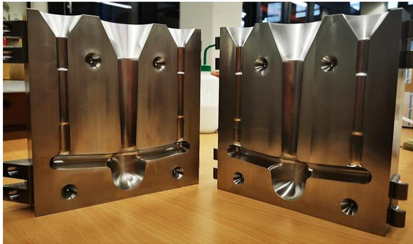
Abbildung 16: Kokille für die Umschmelzversuche für Aluminium- und Kupferlegierungen (Quelle: TH Köln)
