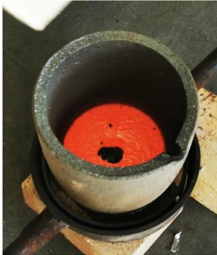
**Abbildung 67:** Schmelzflüssiges Kupfer Cu-DHP direkt nach dem Aufschmelzen (Quelle: TH Köln)
