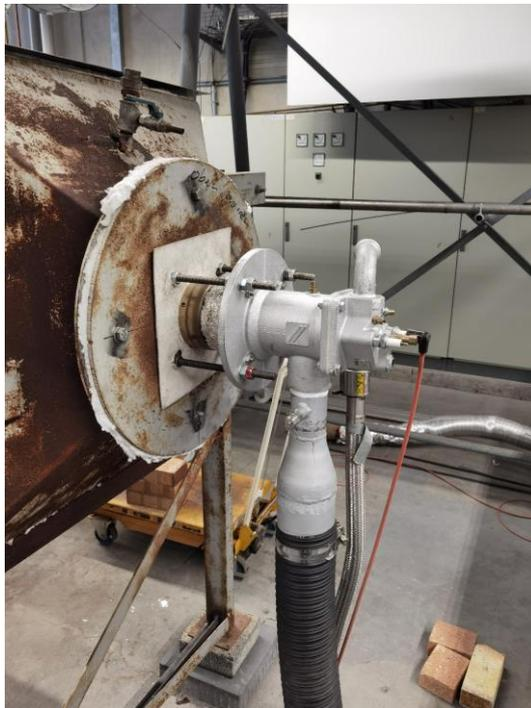
Abbildung 26: Brenner an der Versuchseinrichtung (Quelle: GWI)
