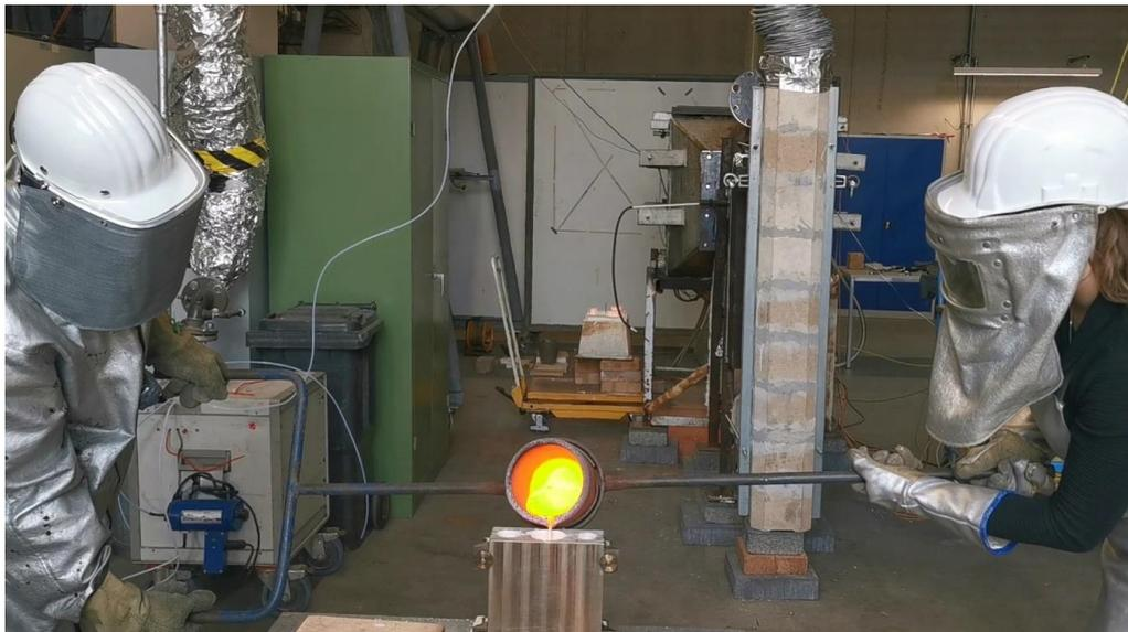
Abbildung 18: Abgießen flüssiger Metallschmelze in eine Stahlkokille (Quelle: GWI)
