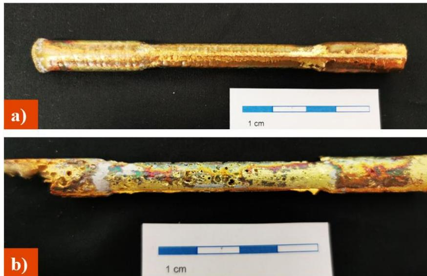
**Abbildung 71: Makroskopische Aufnahme einer abgebrochenen Rundzugprobe aus CuZn39Pb3 bei a) 100 % Erdgas und b) 30 Vol.-% Erdgas und 70 Vol.-% H<sub>2</sub> (Quelle: TH Köln)**
