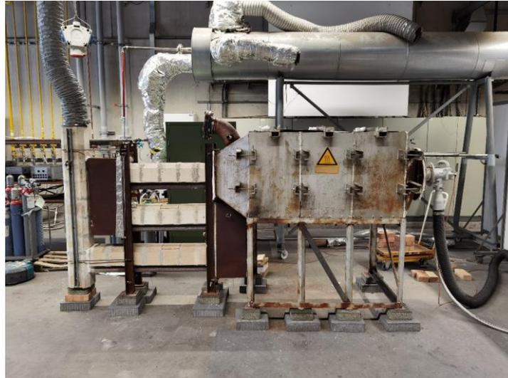
**Abbildung 28: Versuchsbrennkammer am GWI (Quelle: GWI)**
