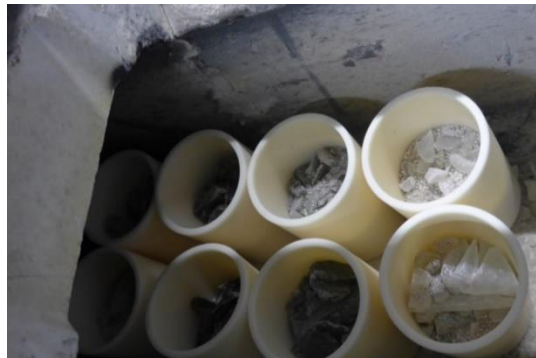
Abbildung 6.2: Tiegel mit Gemenge im untersten Zug 3 des Abgaskanal zum Vorwärmen der Tiegel mit dem Gemenge (Quelle: HVG)
