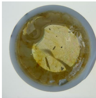
Abbildung 6.9: Fotografie der Glasprobe im Tiegel nach Entfernen des Tiegelbodens im Durchlicht (Quelle: HVG)
