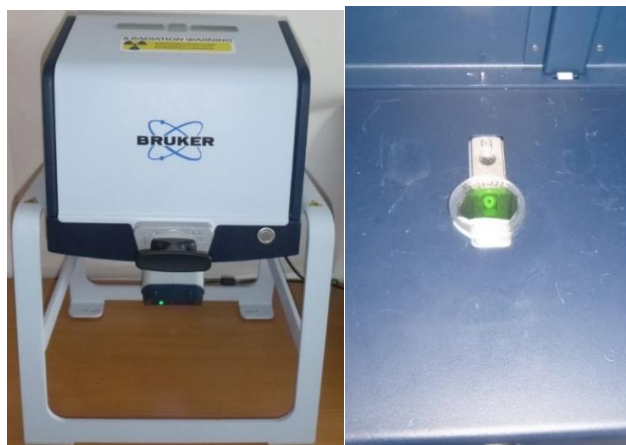
Abbildung 6.11: Links: Die im Projekt verwendete RFA inkl. Probeneinhausung. Rechts: fertig präparierte Spektrophotometerprobe während der Messung (Quelle: HVG)
