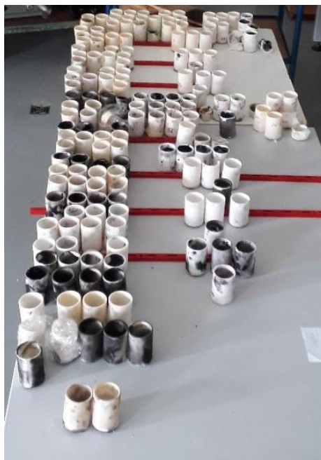
Abbildung 6.8: Tiegel nach Beendigung der Schmelzen, angeordnet anhand der Versuchsbedingungen (Quelle: HVG)
