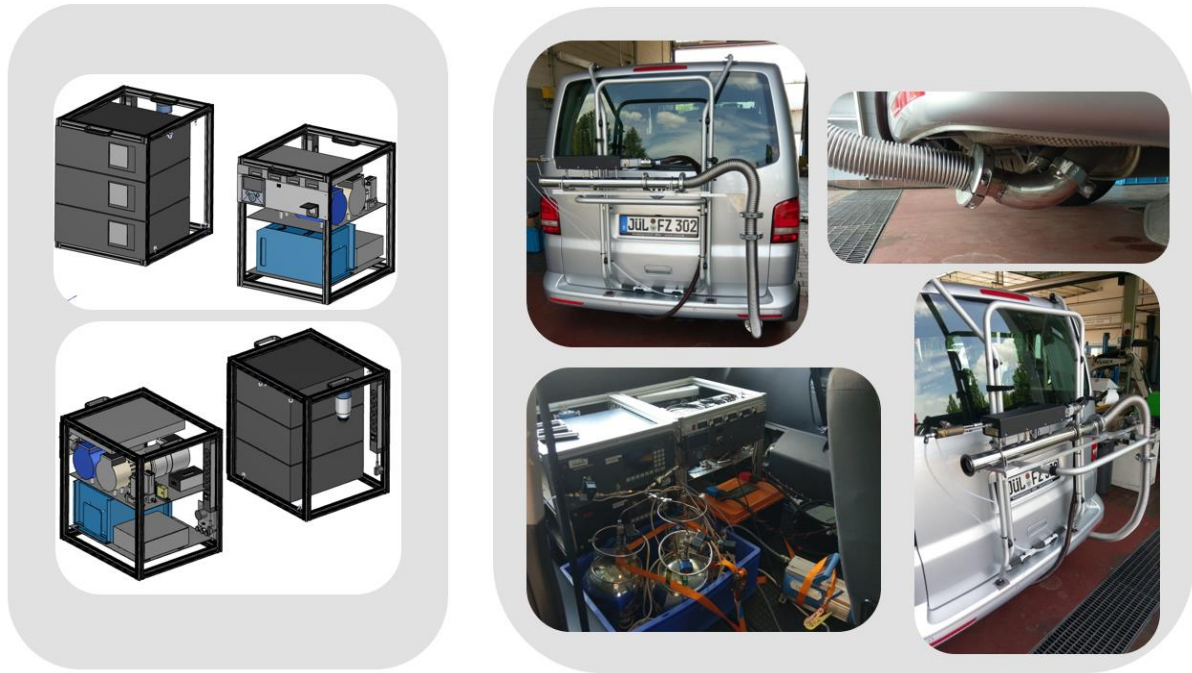
Abbildung 151: Messaufbau des on board Emissionsmesssystems in dem Versuchsfahrzeug Volkswagen T5 2.0 TDI.
