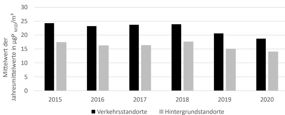
Abbildung 36: Mittelwert der Jahresmittelwerte nach jeweiligem Stationstyp und Jahr in \mu\text{g}_{\text{PM}_{10}}/\text{m}^3 nach [99, S. 15]
