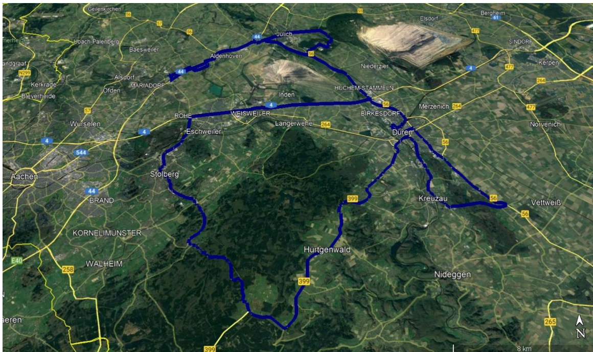
Abbildung 154: Referenzroute für die RDE-Messkampagne (Länge: 144 km, Fahrtzeit 3 Stunden 10 Minuten, Höhe über NN MIN: 83 m MAX: 380 m).
