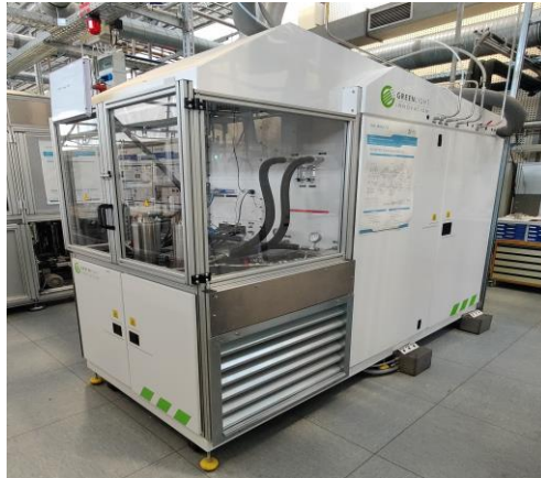
Abbildung 18: 30 kW PEM Elektrolyseur in der Teststandumgebung am IEK 14
