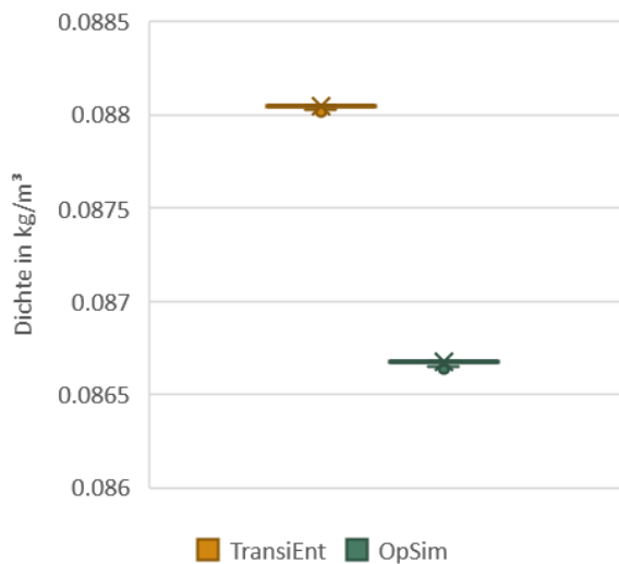
Abbildung 2-15 Auftretende Variation der Dichte innerhalb des Gasnetzes für die beiden Modellansätze TransiEnt und OpSim – a) Netz mit 100 % Wasserstoff; b) Einspeisung von Wasserstoff in Erdgas
