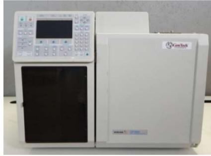
Abbildung 5-5: Gas-Chromatograph der Firma Varian, Typ GC CP 3800, [23]
