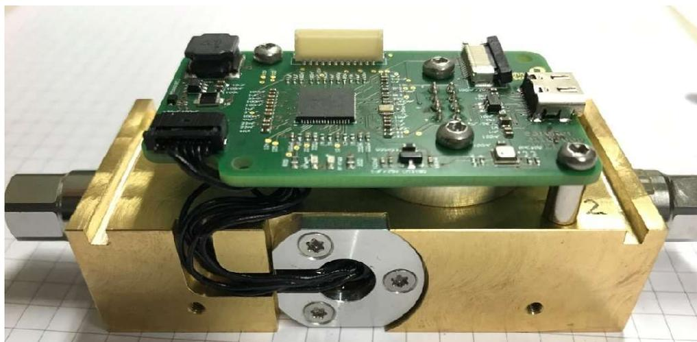
**Abbildung 4-54: Im Grundkörper montiertes Flow-Modul**
