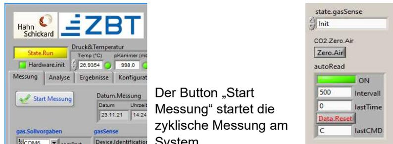
Der Button „Start Messung“ startet die zyklische Messung am System.
