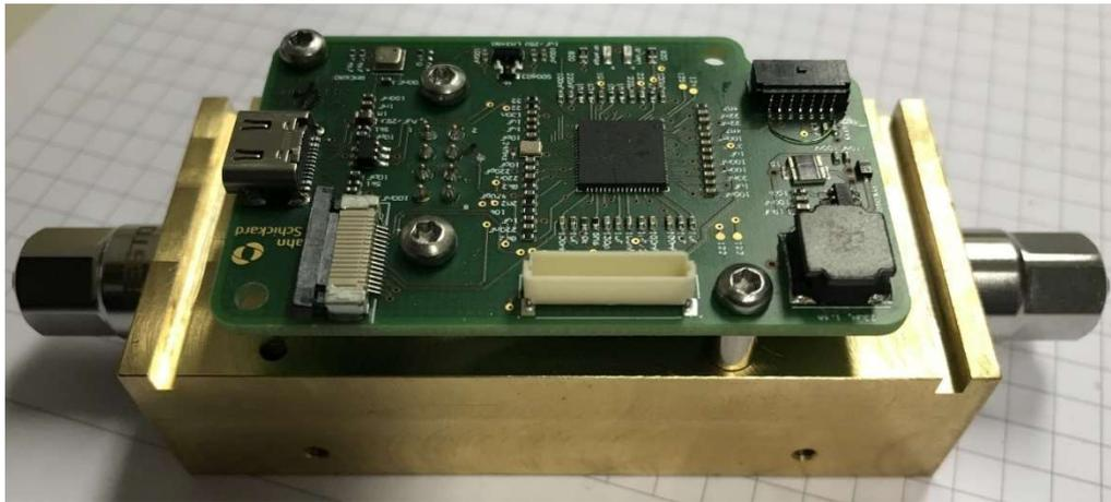
**Abbildung 4-52: Über zwei Abstandshülsen und den Adapterring wird die Hauptplatine aufgeschraubt**
