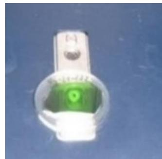
**Abbildung 64: Links: Die im Vorhaben verwendete RFA inkl. Probeneinhausung. Rechts: Fertig präparierte Spektroskopie-Probe während der Messung (Quelle: HVG)**
