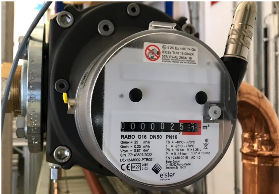
Abbildung 3-59: Drehkolbengaszähler am GWI (Foto GWI)
