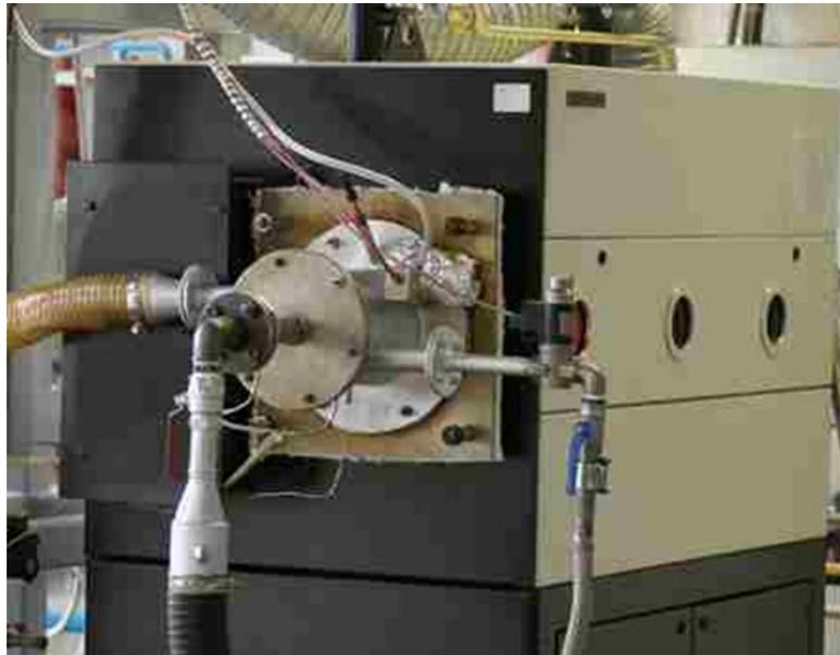
Abbildung 18: Prüfflammrohr mit Installation (Quelle: GWI)
