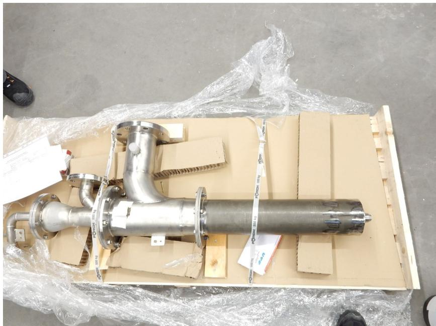
**Abbildung 13: Verwendeter Drall-Brenner (Quelle: GWI)**
