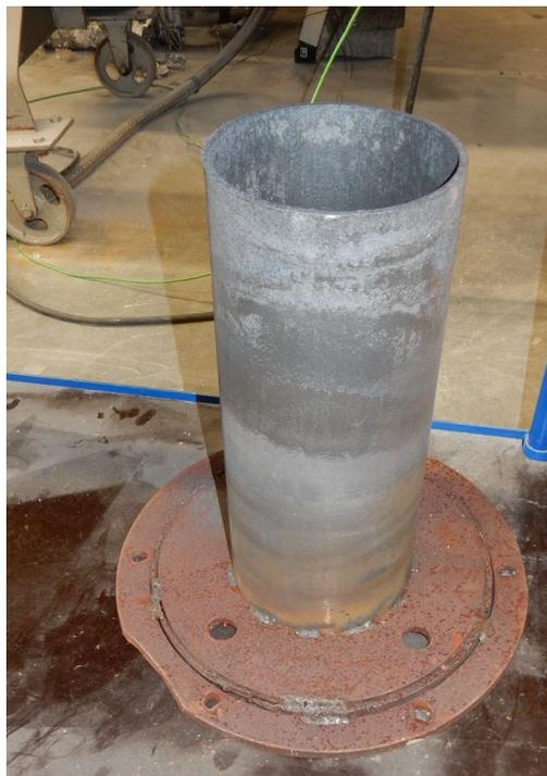
Abbildung 25: Ansicht des verwendeten Flammenrohrs
