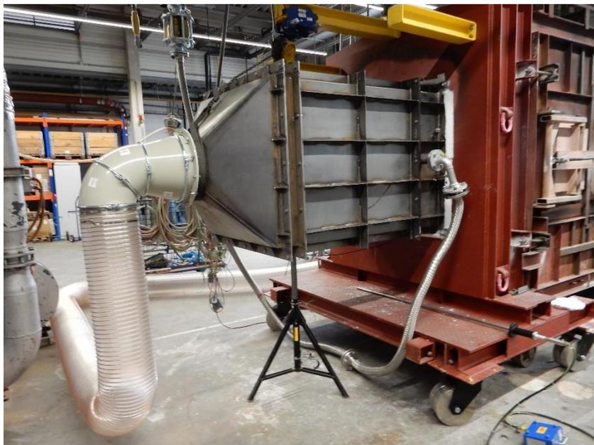
Abbildung 4.2.2.2 Am Ofen angeschlossener Brenner mit Prozessluftzuführung
