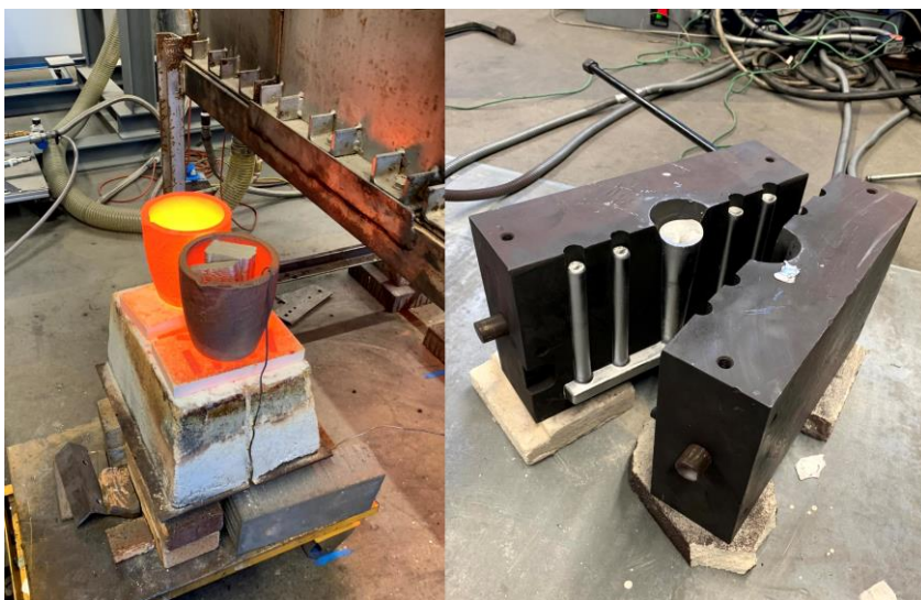
Abbildung 3-30: Abgusszenario der im Graphittiegel geschmolzenen Materialproben (Quelle: GWI)
