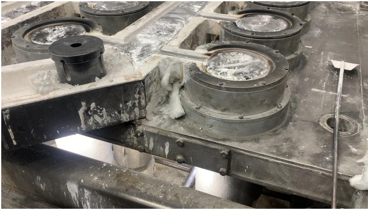
Abbildung 3-13: gefüllter Gießverteiler während des Gießprozesses (HMT)
