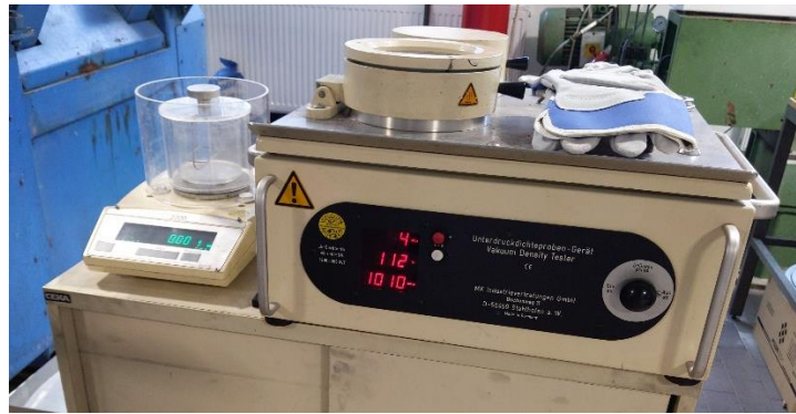
Abbildung 3-17: Dichte-Index Waage und Unterdruckdichteprobe-Gerät Serie 3 VT der Fa. MK Industrievertretungen GmbH (OVGU)
