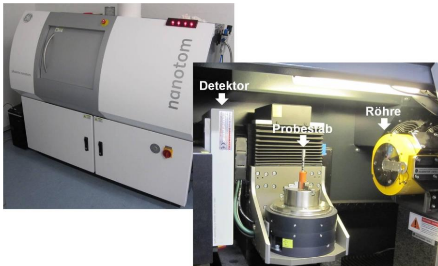
Abbildung 3-23: \mu CT Typ Nanotom S des Herstellers GE mit Darstellung der Messkammer (OVGU)
