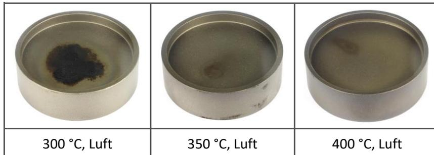
*Abbildung 4.13: Rückstand aus der Verdampfung von Heizöl extra leicht (HEL) für verschiedene Temperaturen. (Quelle: OWI)*
