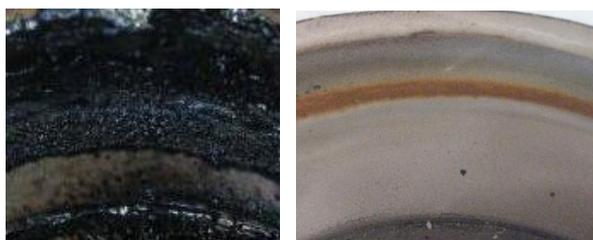
Abbildung 2.3: Verdampferoberfläche eines Vormischbrenners nach 100 Betriebsstunden mit a) Heizöl EL schwefelarm +5 % FAME und b) nach Anhebung der Verdampfertemperatur [15].
