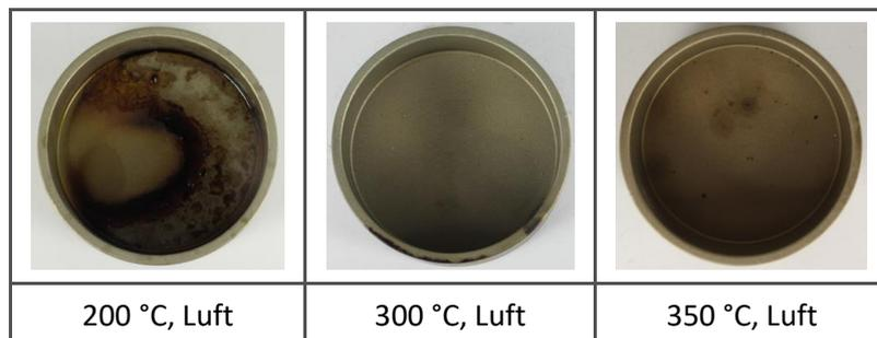
*Abbildung 4.14: Rückstand aus der Verdampfung von hydriertem Pflanzenöl (HVO) für verschiedene Temperaturen. (Quelle: OWI)*
