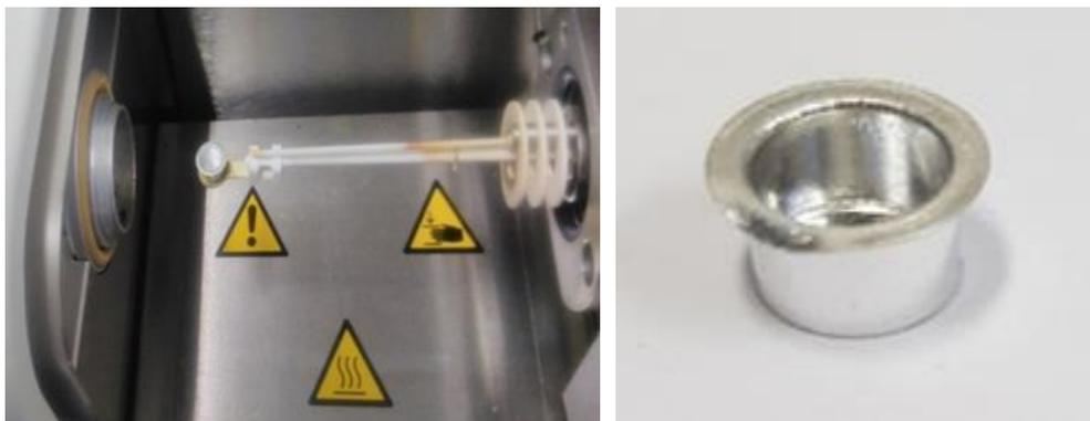
Abbildung 4.2: TGA mit geöffnetem Ofen (links), Aluminiumtiegel ( $100 \mu\text{L}$ , rechts). (Quelle: OWI)
