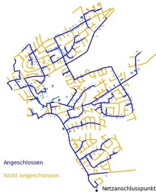
Abbildung 3-4: Netzausbau ausgehend von bestehenden Netzabschnitten
