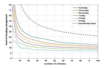
Abbildung 11-5: Einfluss unterschiedlicher Eingriffstiefen des Netzbetreibers ("level of charging management") sowie der Anzahl von Fahrzeugen in einem Verteilnetz ("number of vehicle") auf die durchschnittliche Aktivierungsdauer des Lademanagements
