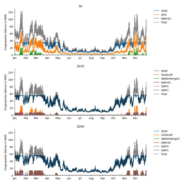
Abbildung 8-1: Verlauf der Wärmeeinspeisung aller Einspeiser der Szenarien
