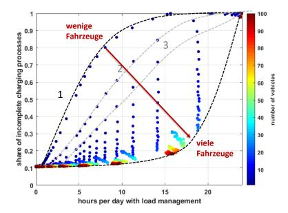
Abbildung 11-7: Einfluss unterschiedlicher Eingriffsdauern auf die Anteile nicht vollständiger Ladevorgänge. Die Farbe der Punkte differenziert das Ergebnis zudem nach Anzahl der Fahrzeuge in einem Verteilnetz
