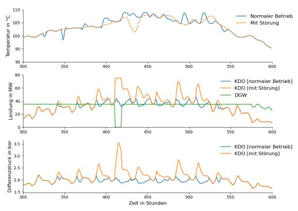
Abbildung 8-12: Betriebsparameter eines kritischen Verbrauchers (Krankenhaus) sowie Differenzdruck des Heizwerks KDO
