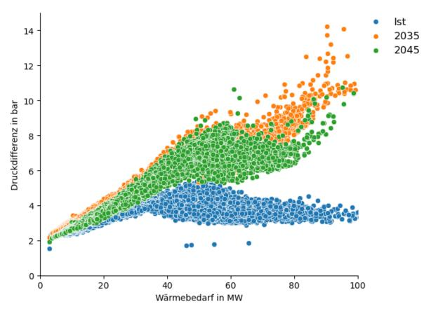
Abbildung 8-4: Streudiagramm der Druckdifferenzen gegenüber des gesamten Wärmebedarfs am Standort DGW
