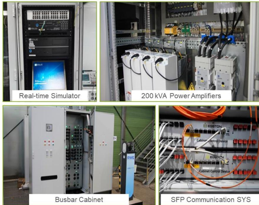
Abbildung 10-8: Echtzeit-Simulator und Leistungsverstärkersystem
