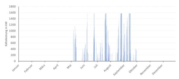
Abbildung 6-8: Jahresverlauf Gesamtkältebedarf für die Wetterzeitreihe 2016
