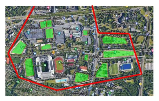
Abbildung 9-3: Übersicht über die potenzielle Dachfläche für PV-Anlagen im Bereich Stadion (TP5)
