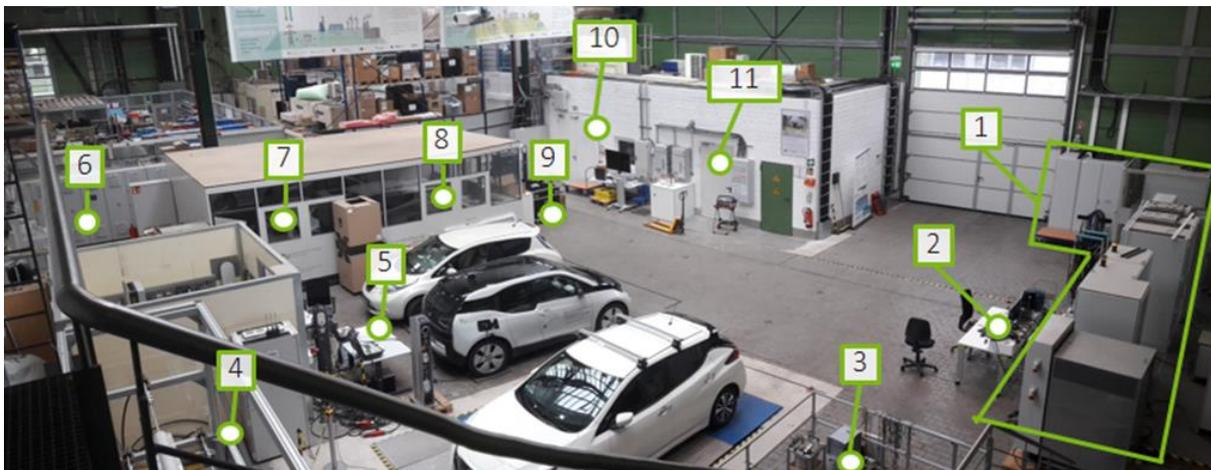
Abbildung 10-1: Blick in das Smart Grid Technology Lab (SCTL) - (1) Entwicklungsumgebung, (2) Mobiler Arbeitsplatz, (3) Prüfstand für Spannungsregler, (4) Prüfstand für Impedanzregler, (5) Prüfstand für EV-Ladestationen, (6) 200-kVA-Leistungsverstärker, (7) Meetingraum, (8) Arbeitsplatz + Opal RT Simulator, (9) Arbeitsplatz 5G-Nachbildung, (10) Serverraum, (11) rONT
