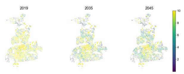
Abbildung 6-5: Wärmeliniendichte des Netzgebietes für 2019, 2035 sowie 2045
