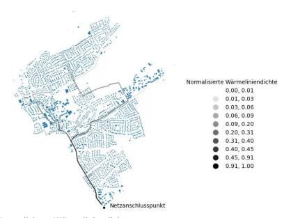
Abbildung 3-3: Normalisierte Wärmeliniendichte
