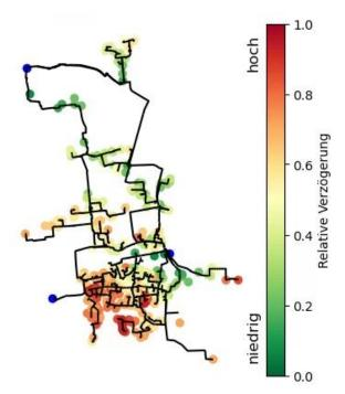
Abbildung 8-9: Relative Verteilung der Verzögerung der Vorlauftemperaturen im Netzbereich (Ist-Zustand)
