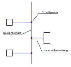
Abbildung 3-2: Schematische Darstellung der Schnittmethode
