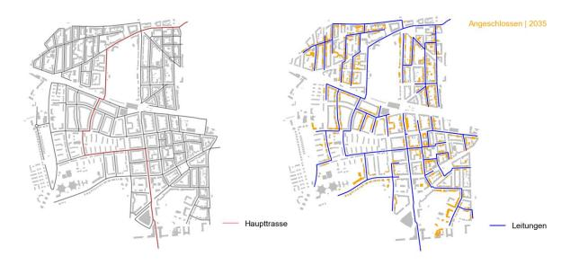
Abbildung 6-11: Darstellung des Trassenverlaufs für den initialen Anschluss des Kreuzviertels 2035
