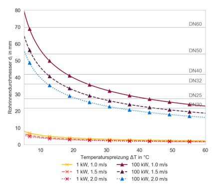
Abbildung 2-1: Rohrinnendurchmesser  $d_i$  nach Formel 2 in Abhängigkeit der Temperaturspreizung  $\Delta T$  für verschiedene Leistungen  $\dot{Q}$  und Mediengeschwindigkeiten v
