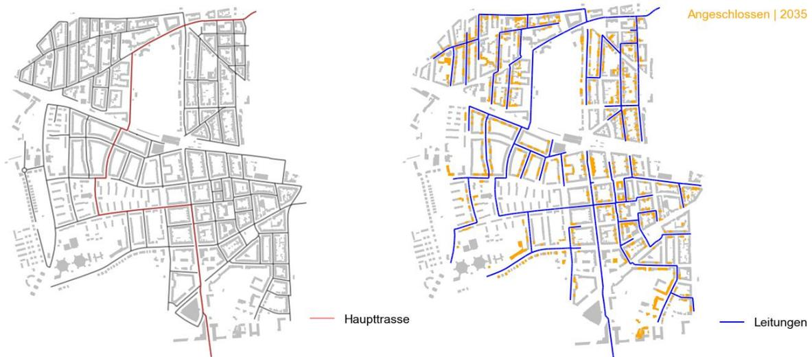
Abbildung 6-11: Darstellung des Trassenverlaufs für den initialen Anschluss des Kreuzviertels 2035
