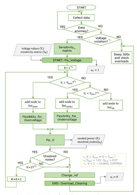
Abbildung 10-10: Implementierte Algorithmus für die Spannungsregelung
