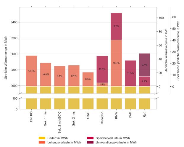
Abbildung 7-6: Wärmeenergienachfrage (Primärachse) sowie absolute jährliche und spezifische Wärmeverluste (Sekundärachsen) des Kronprinzenviertels für die Szenarien
