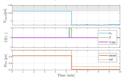
Abbildung 10-15: Überspannung aufgrund von hoher Einspeisung durch PV-Anlagen gelöst
