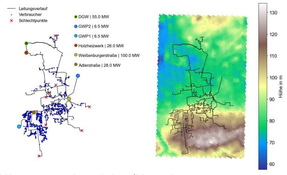
Abbildung 6-10: Netzzustand 2035 und Höhenprofil des Netzgebietes
