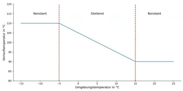
Abbildung 6-1: Darstellung der im Basis-Szenario verwendeten Vorlauftemperaturregelung
