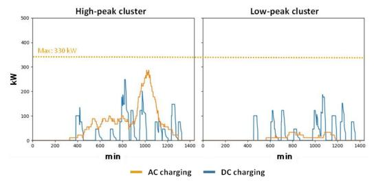
Abbildung 10-6: Cluster für EV-Ladeprofile aus der Simulation basierend auf MID-Daten
