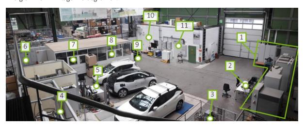
Abbildung 10-1: Blick in das Smart Grid Technology Lab (SGTL) - (1) Entwicklungsumgebung, (2) Mobiler Arbeitsplatz, (3) Prüfstand für Spannungsregler, (4) Prüfstand für Impedanzregler, (5) Prüfstand für EV-Ladestationen, (6) 200-kVA-Leistungsverstärker, (7) Meetingraum, (8) Arbeitsplatz + Opal RT Simulator, (9) Arbeitsplatz 5G-Nachbildung, (10) Serverraum, (11) rONT
