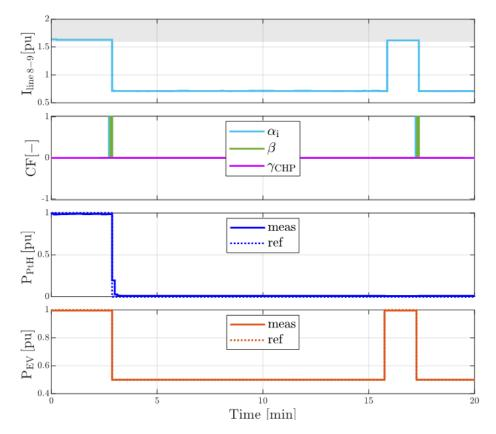
Abbildung 10-13: Überlastung aufgrund des hohen Verbrauchs durch PtH und EV gelöst
