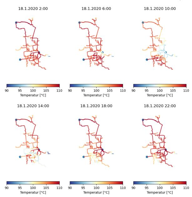
Abbildung 8-11: Ausbreitung der niedrigeren Vorlauftemperatur im Netz bei Ausfall der Abwärme DGW
