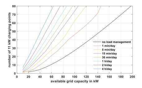
Abbildung 11-6: Anzahl integrierbarer Ladepunkte in Abhängigkeit der vorhandenen Netzkapazität (X-Achse) sowie der Eingriffstiefe des Lademanagements (farbige Linien)
