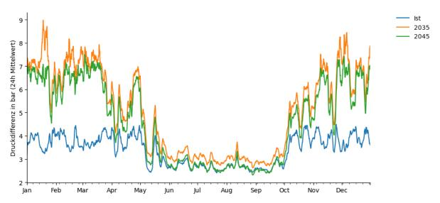
Abbildung 8-3: Druckdifferenz im täglichen Mittel am Einspeiser DGW
