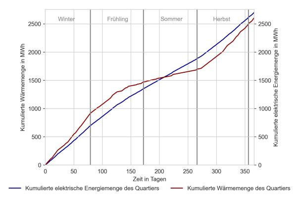
Abbildung 7-5: Zeitlicher Verlauf der kumulierten Strom- und Wärmebedarfe in MWh
