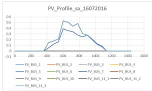
Abbildung 10-5: Ausgewählte Erzeugungsprofile für die simulierten PV-Anlagen aus der SimBench-Datenbank (Werte in pu) - sonniger Tag (Links) und bewölkter Tag (Rechts)
