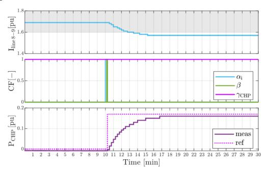
Abbildung 10-12: Überlastung aufgrund des hohen Verbrauchs durch KWK-Anlage gelöst
