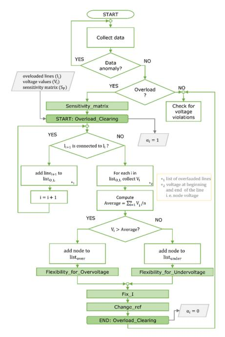
Abbildung 10-11: Implementierte Algorithmus für das Überlastmanagement
