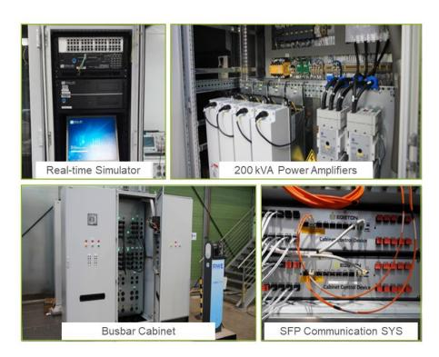
Abbildung 10-8: Echtzeit-Simulator und Leistungsverstärkersystem
