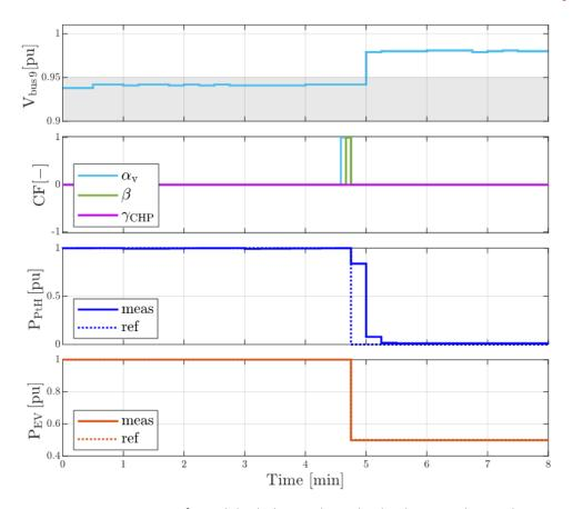
Abbildung 10-14: Unterspannung aufgrund des hohen Verbrauchs durch PtH und EVs gelöst
