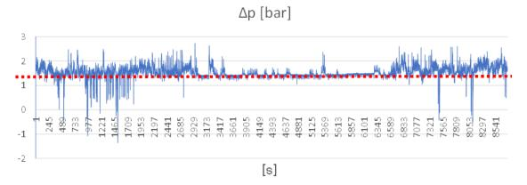
Abbildung 10-7: Differenzdruck ∆p über eine Jahressimulation des KWK-Systems in TP 5
