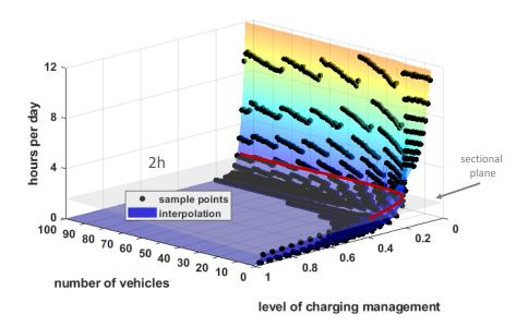
Abbildung 11-4: Einfluss unterschiedlicher Eingriffstiefen des Netzbetreibers ("level of charging management") sowie der Anzahl von Fahrzeugen in einem Verteilnetz ("nuber of vehicle") auf die durchschnittliche Aktivierungsdauer des Lademanagements
