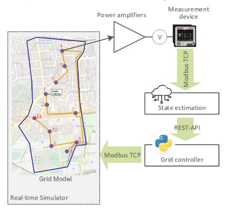
Abbildung 10-2: Überblick der konzipierten Hardware-in-the-Loop-Setup
