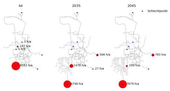
Abbildung 8-5: Anzahl der Stunden in denen die definierten Schlechtpunkte als Basis der Schlechtpunktregelung festgelegt sind
