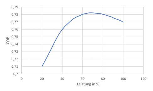
Abbildung 6-7: COP in Abhängigkeit der Kälteleistung für die AKM "YHAU CL/CH 500EXE" nach [45]
