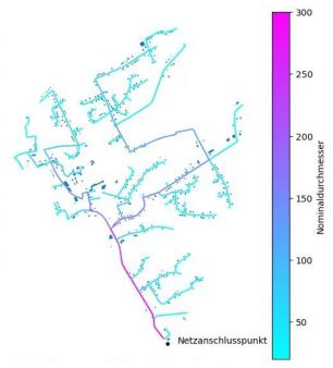
Abbildung 3-5: Repräsentative Darstellung der resultierenden Dimensionierung
