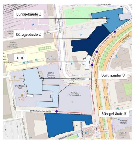
Abbildung 6-6: Kältenetz im Bereich Dortmunder U, LOD1 [18], Open Street Map [44]
