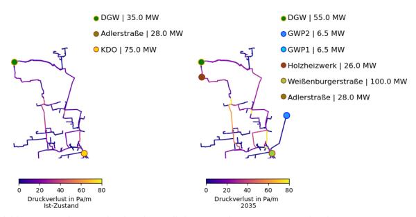
Abbildung 8-2: Mittlerer Druckverlust des nördlichen Netzgebietes im Ist-Zustand und Szenario 2035
