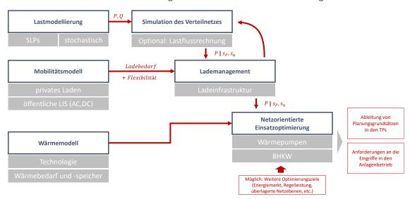
Abbildung 11-1: Bausteine und Ablaufdiagramm des entwickelten Simulationsmodells
