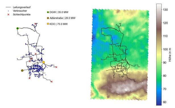
Abbildung 6-9: Netzzustand im Ist-Zustand sowie topographische Karte des Netzgebietes
