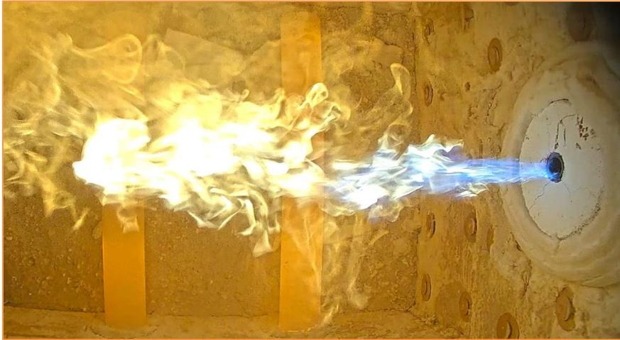
Abbildung 5-5: Oxyfuel-Brenner im Versuchsofen mit Erdgasflamme 100 kW (Quelle: GWI)
