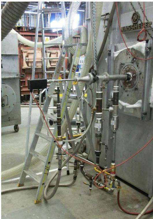
**Abbildung 3-11: Betriebsfähig installierter Brenner (Quelle: GWI)**
