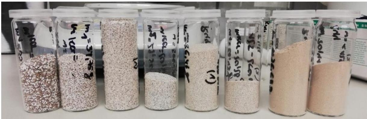
**Abbildung 4-14:** Edelmetallkatalysator in verschiedenen Korngrößen (v.l.n.r. > 710 µm, 710 – 500 µm, 250 – 125 µm und < 125 µm) (Quelle: DBI)
