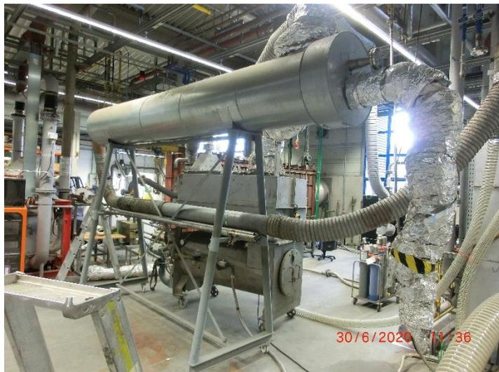
**Abbildung 3-14: Seitenansicht des Gaserhitzers (Quelle: GWI)**
