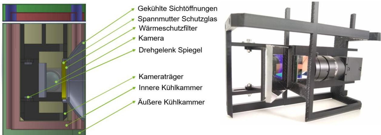
*Abbildung 5.4: Links ist der schematische Aufbau und Zusammenbau des Kameramoduls zu sehen. Rechts ist der finale Aufbau zu sehen, wie er zehnmal in das Kühlmodul eingesetzt wird.*
