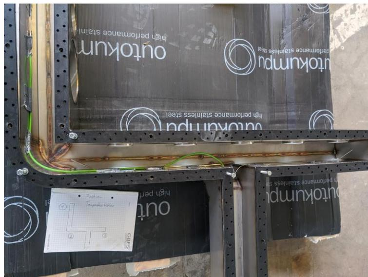
*Abbildung 5.5: Ausstattung des leeren Kühlmoduls mit Thermoelementen für erste Testläufe im DBI-Ofen. Zu sehen ist die Deckeldichtung (schwarz, gelocht) welche den Doppelwandigen Deckel und die Wasserkammern gegen die Elektronik abdichtet.*
