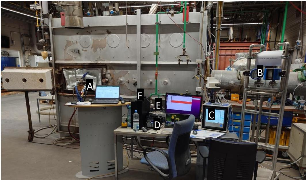
*Abbildung 6.5: Versuchsaufbau für die Erprobung der Kamerasonde im „Nassheuer“-Ofen – Fall 1. A: Kühlwasserdurchflussmesser, B: Druckluftversorgung, C: Temperatur-Logger, D: Pulsgeber, E: Verteilerbox Trigger-Puls, F: PC für Kamerasteuerung und Bilddatenspeicherung.*
