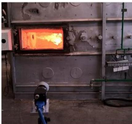
*Abbildung 4.9: Erfassung der CH\*-Chemilumineszenz einer 150-kW-Flamme durch die geöffnete Kammerklappe des „Nassheuer“-Ofens bei einer mittleren Ofenraumtemperatur von 1.140 °C.*
