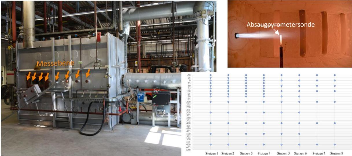
**Abbildung 3.37:** Darstellung der 2D-Feldmessung; links: Aufnahme der Messöffnungen am Nassheuer Ofen, rechts unten: Messraster der Absaugpyrometersonde, rechts oben: Aufnahme des Ofenraums während einer Feldmessung (Quelle: GWI)
