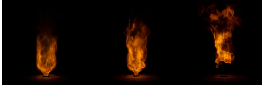
Abbildung 2.2: Aerodynamische Stabilisierung von \text{NH}_3 -Flammen mit sinkender Drallintensität von l. n. r., collagiert [9]
