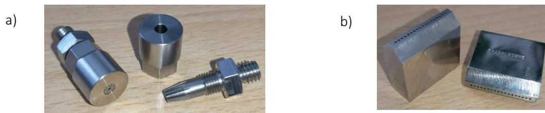
Abbildung 82: Verschiedene Brennertypen (a) Einlochröhrbrenner, b) Linienbrenner) aus dem Bereich der Heißformgebung (Quelle: SCHOTT/TUBAF)
