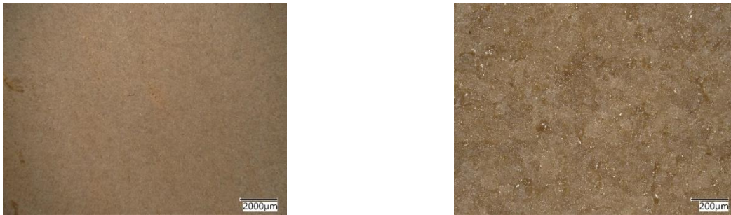
Abbildung 14: Mikroskopische Aufnahmen der inhomogenen Probenoberflächen von des Materials HZFC nach der Auslagerung bei 1.500 °C unter Wasserstoff-Verbrennungsatmosphäre (Quelle: TUBAF)
