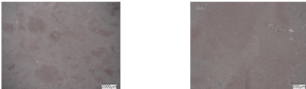
Abbildung 18: Mikroskopische Aufnahmen der inhomogenen Probenoberflächen von des Materials Korund nach der Auslagerung bei 1.500 °C unter Wasserstoff-Verbrennungsatmosphäre (Quelle: TUBAF)
