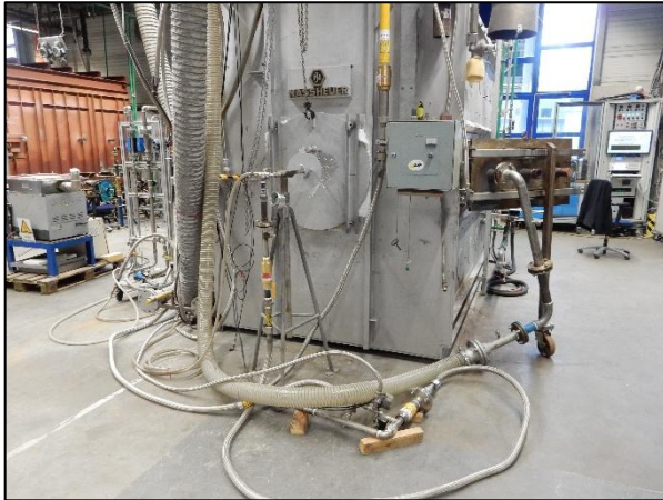
Abbildung 7.2: Versuchsanlage mit eingebautem Lanzenbrenner (Quelle: GWI)
