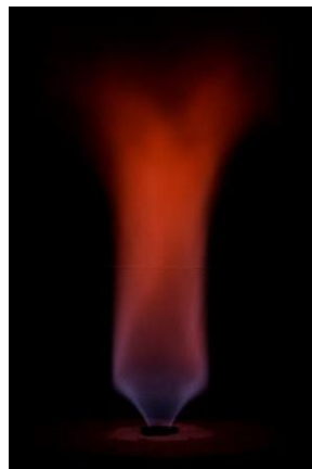
Abbildung 6.4: Fotografische Aufnahme einer 8-kW Wasserstoff-Luft-Flamme mit abweichender Kameraeinstellung (Quelle: GWI)
