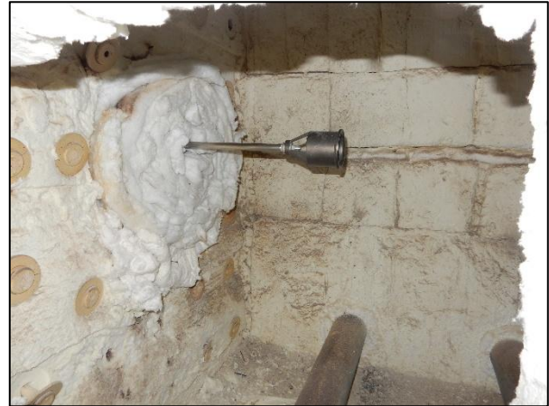
Abbildung 7.2: Versuchsanlage mit eingebautem Lanzenbrenner (Quelle: GWI)
