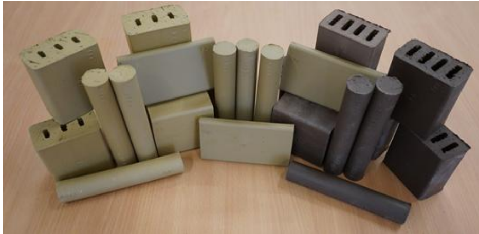
Abbildung 8.2: Gefertigte Prüfkörper für die Versuchsdurchführung (Quelle IZF)
