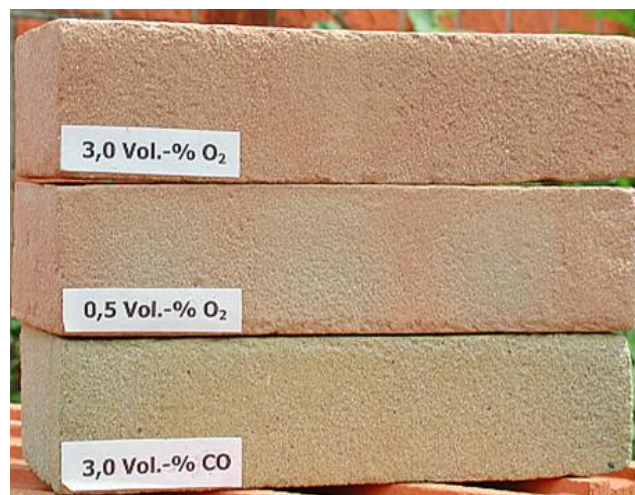
Abbildung 3.3: Einfluss der Atmosphäre auf die Brennfarbe (Quelle: IZF)
