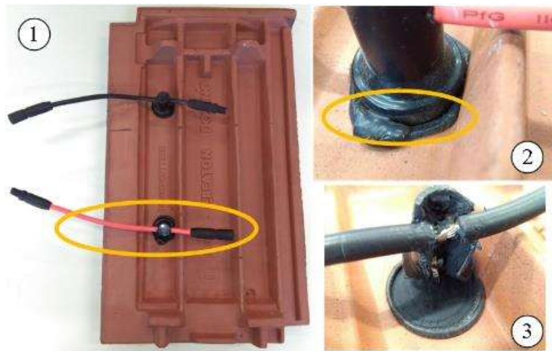
Abbildung 182: Vollflächiger Ziegel mit defektem elektrischem Kontakt
