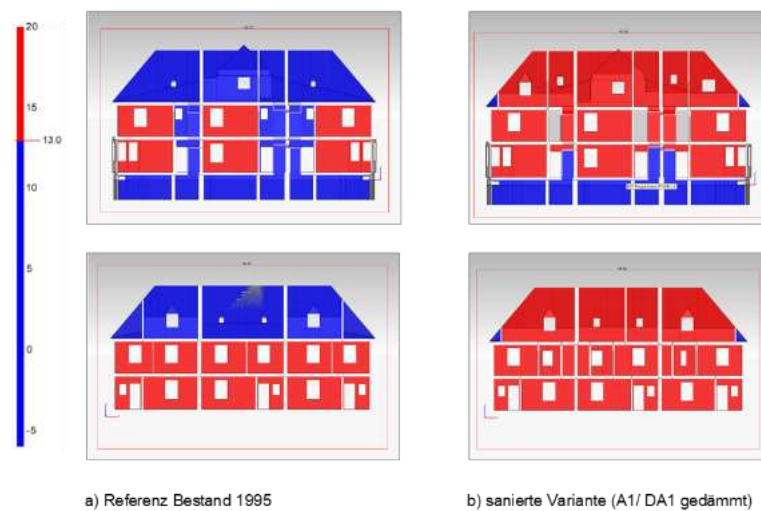
Abbildung 77: Innenoberflächentemperaturen bei 13 °C, Metzendorfstraße 38 ABC
