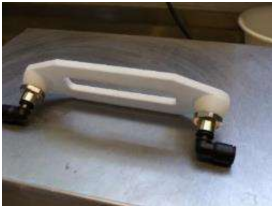
Abbildung 167: Im 3D-Druck hergestellte Twin-Channel-Wärmetauscher mit montierten, drehbaren Anschlüssen für die Leitungen
