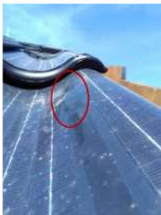
Abbildung 266: Typ-2 Blasenbildung unter Laminat
