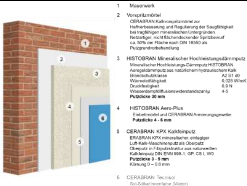
Abbildung 274: Schichtaufbau des Dämmsystems
