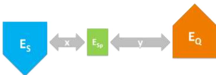
Abbildung 217: Räumlicher Zusammenhang der Senke, der Quelle und des Speichers. Dabei können sich alle Komponenten im selben Gebäude befinden oder über mehrere Gebäude hinweg vernetzt und auch mehrfach vorhanden sein
