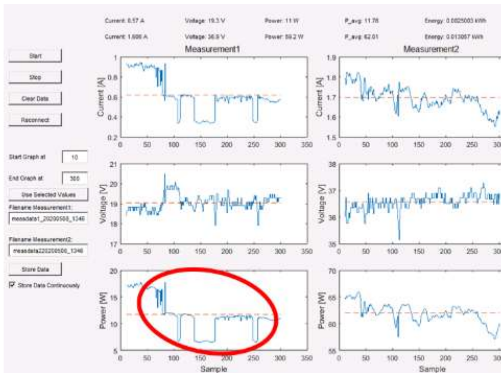
Abbildung 263: Vergleichsmessung mit Leistungseinbruch durch Kontaktprobleme im Kabelbaum
