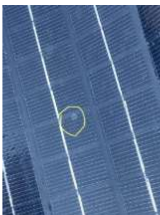
Abbildung 267: Typ-2 Blasenbildung in Laminierung
