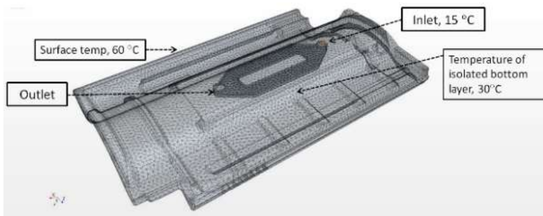
Abbildung 164: Thermische Randbedingungen der CFD-Simulation an der Ober- und Unterseite des Dachsteins und Eintrittstemperatur des wärmeaufnehmenden und -abführenden Fluids (Wasser-Glykol-Gemisch)
