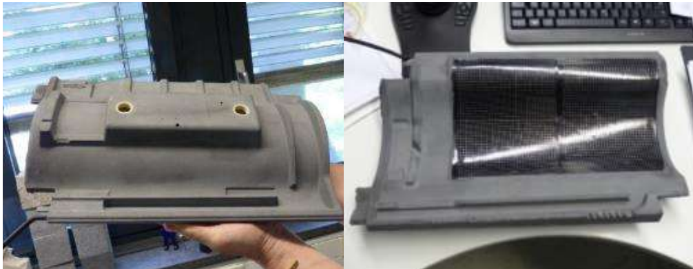
Abbildung 169: Unterseite mit Wärmetauscher und Oberseite mit CIGS-Modul des Betondachsteins
