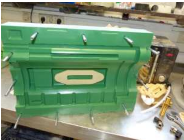
Abbildung 168: Unterseite der Schalung für den Betondachstein mit montiertem Twin-Channel-Wärmetauscher in der Mitte
