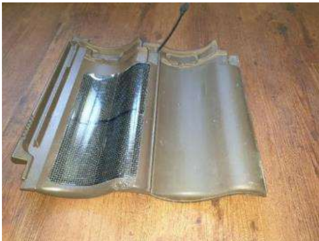
Abbildung 170: Betondachstein mit Twin-Channel-Wärmetauscher und CIGS-PV-Modul (links) neben einem im Quartier eingesetzten Standardziegel
