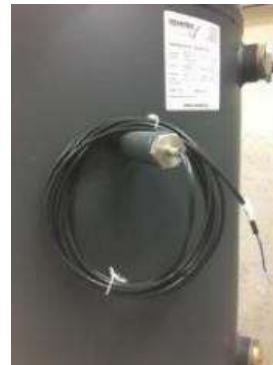
Abbildung 209: Anordnung der Temperatursensoren (a) Bezeichnung und schematische Verteilung der Temperatursensoren (b, c) Installation der Temperatursensoren
