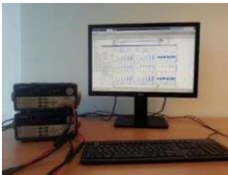
Abbildung 177: Elektronische Lasten und Messprogramm
