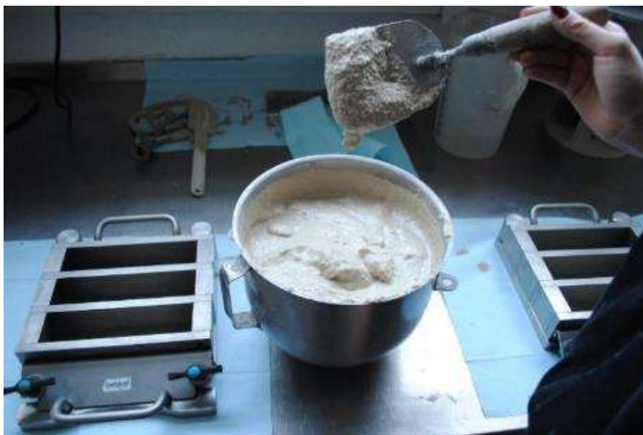
Abbildung 137: Frisch angemischter Hochleistungsdämmputz
