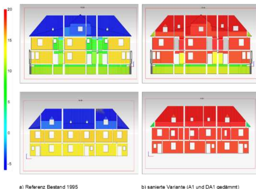
Abbildung 75: Innenoberflächentemperaturen [°C], Metzendorfstraße 38 ABC
