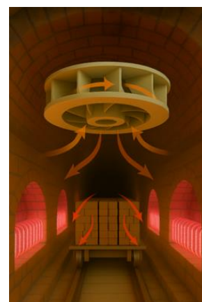
Tunnelofen mit Lüfterrad, um die Ofenatmosphäre zu vermischen
