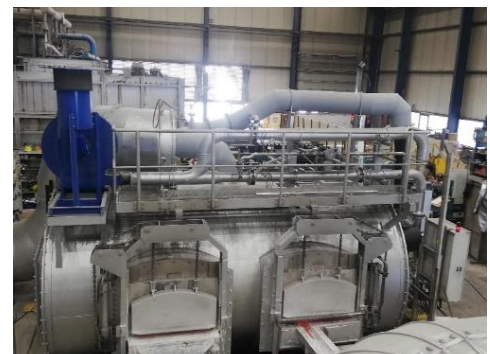
Gießofen zur Sekundär-Aluminiumherstellung © HMT Höfer Metall Technik GmbH & Co KG
