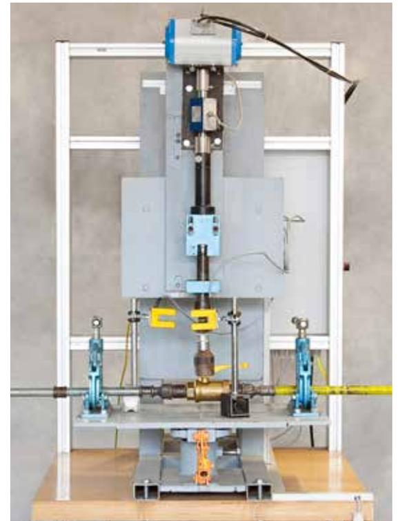
DAUERPRÜFUNG VON ARMATUREN IM ANWENDUNGSBE-
