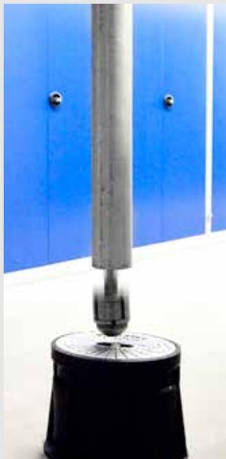
TEST VON STRASSENKAPPEN AUS PE, PA UND GUSSMATERIAL
