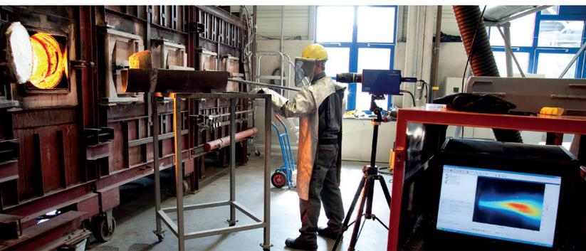
H<sub>2</sub>-VERSUCHSREIHE AN DER SEMI-INDUSTRIELLEN ANLAGE MIT EINER LEISTUNG VON 1,3 MW
